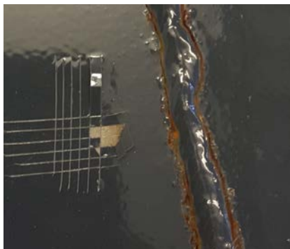
◀ Bild 14: Prüfblech mit nicht vorbereiteter Schweißnaht nach bereits 168 h im neutralen Salzsprühversuch
