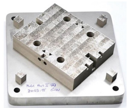
Abb. 2: Design und Umsetzung von komplexen Kühlgeometrien in Gussformen mittels additiver Fertigungsverfahren
