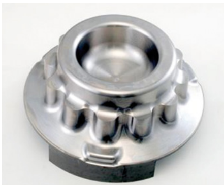
Abb. 3: HSC-Bearbeitung einer Testform aus gehärtetem Material mit CBN-Werkzeugen
