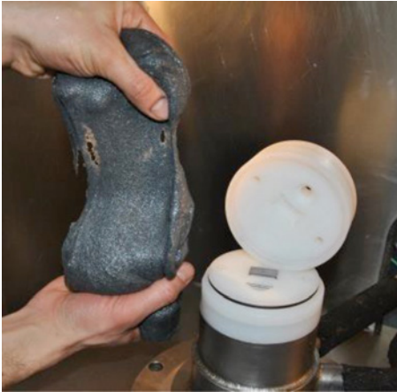
Abb. 5: Viskoelastisches polymeres Trägermedium (links) und vergrößerte Darstellung der darin enthaltenen Silicium-Carbid-Partikel (rechts) für das Strömungsschleifen
