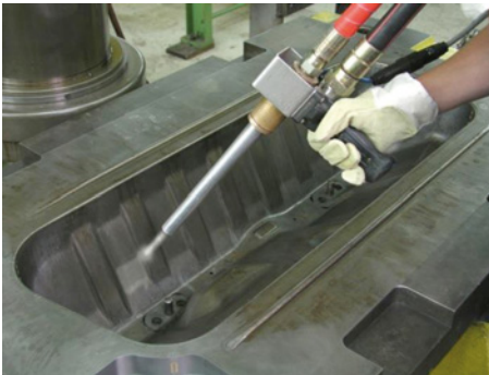
Abb. 6: CO 2 -Trockeneisstrahlen (links) und CO 2 -Schneestrahlen (rechts) zur Formenreinigung
