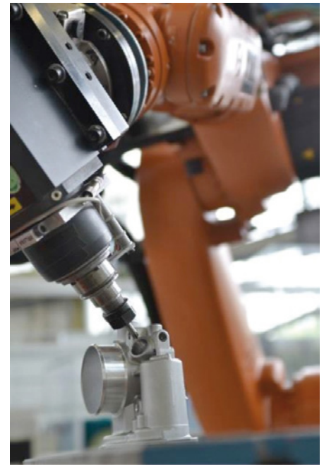
Abb. 4: Robotergestützte Kantenbearbeitung von Aluminiumguss
