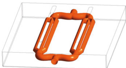
Abb. 1: Simulationsgestützte Auslegung der Kühlgeometrien in Spritzgusswerkzeugen zur Verkürzung der Taktzeiten
