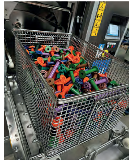
Reinigung und Trocknung von Kunststoffteilen als Schüttgut in einem Waschkorb (Bild: BvL Oberflächentechnik)
