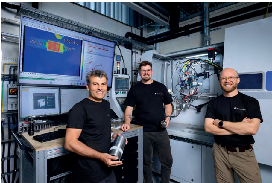
Im Projekt RePEEK entwickelt Dr. Samuel Moritz Fink (r.) gemeinsam mit Rebar Hama-Saleh Abdullah (l.) und Julius Funke ein neuartiges Verfahren, um PEEK laserbasiert auf metallische Bauteile aufzubringen (© Fraunhofer ILT, Aachen)
