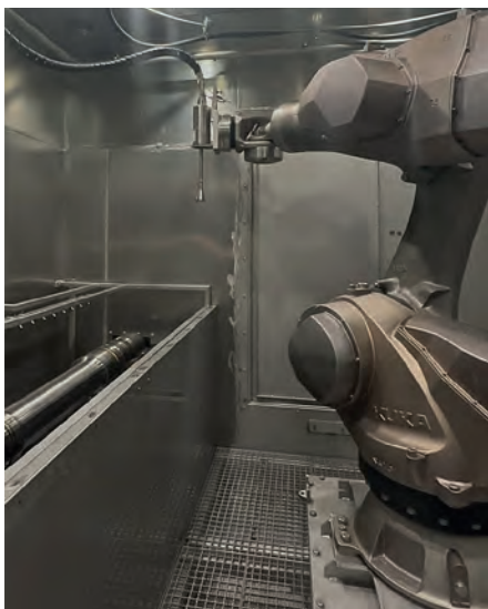
Vollautomatisierte BvL Reinigungs- und Entlackungsanlage vom Typ Geyser mit robotergeführter Hochdruckwassertechnik (Bild: BvL Oberflächentechnik)
