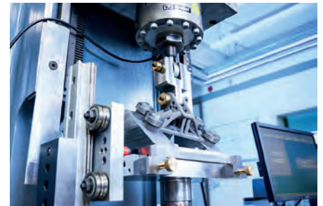
Zyklische Belastungsprüfung eines additiv gefertigten Metallbauteils nach einer mechanischen Oberflächenbehandlung an den hochbeanspruchten Zonen zur Ermittlung des Lebensdauererfolgs durch die Nachbehandlung (Bild: Fraunhofer IWM / Kai Wudtke)
