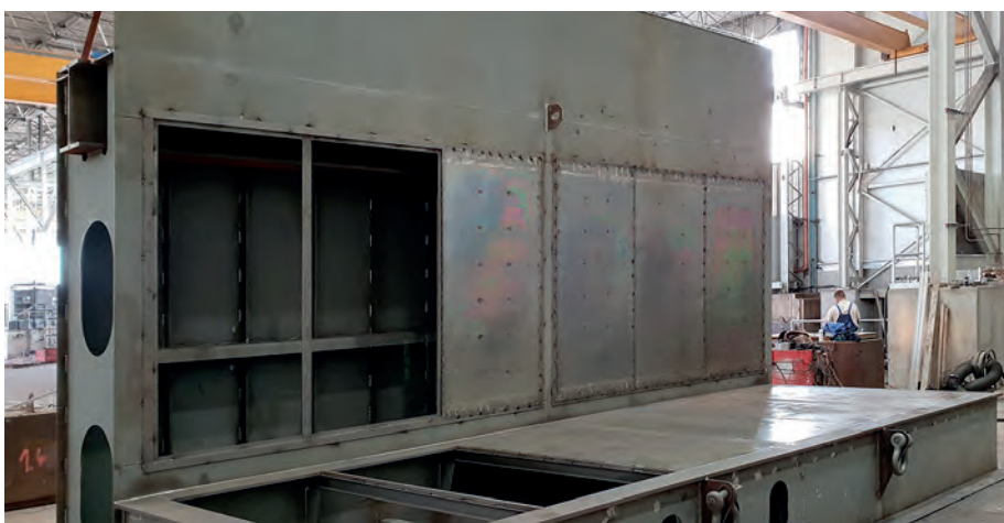
Prototyp eines Laderaumbereichs (eine Hälfte) für ein Container-Binnenschiff; die verwendeten Sandwiches haben ein Abmaß von 2 m x 1 m mit Dicken von 14 mm bis 28 mm (© Fraunhofer IWU)
