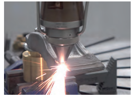
Im Projekt AI-SLAM zeigen die Forschenden des Fraunhofer ILT gemeinsam mit internationalen Partnern, dass sich Beschichtungs- und Reparaturprozesse mithilfe von Sensorik und Künstlicher Intelligenz automatisieren lassen (© Fraunhofer ILT)
