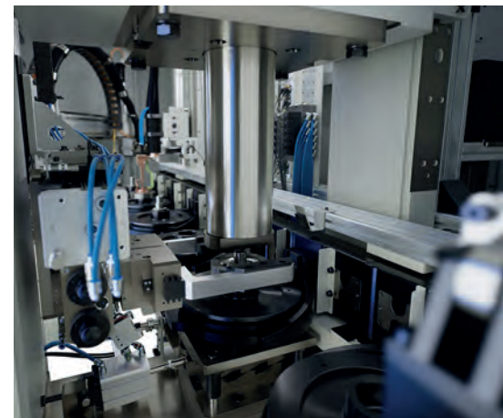
Innenansicht der ELC 6i mit integrierten Prozessstationen: Pressen, Laserreinigen, Laserschweißen und Lasermarkieren (Bild: EMAG)
