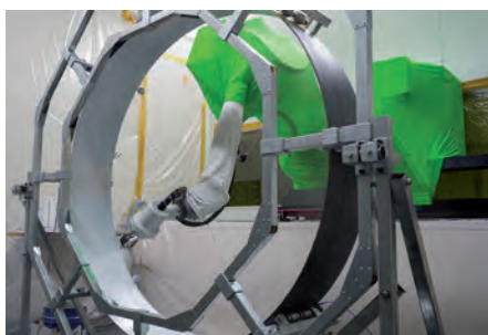
Automatisierte Applikation der Barrierschicht mittels Lackierroboter und konventioneller Automatikpistole (Bild: Fraunhofer IFAM)
