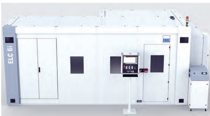
Kompakte Laserschweißanlage ELC 6i mit integriertem Rundtaktsystem und zentraler Steuerung für bis zu sechs Prozessschritte, ausgelegt für die Serienfertigung von Powertrain-Komponenten (Bild: EMAG)
