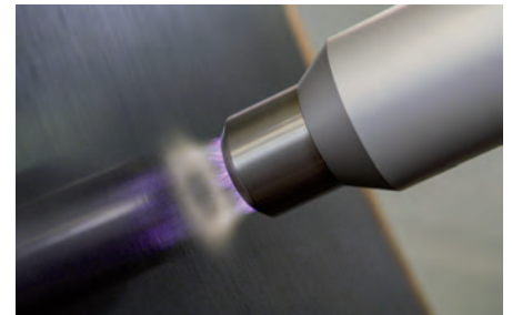
Kontaktfreie Atmosphärendruckplasma-Vorbehandlung einer CFK-Oberfläche
