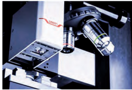
Abb. 6: Das UNHT 3 Ultra-Nanoindentationsgerät mit der patentierten Oberflächenreferenzierung
