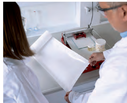
Neue Batteriematerialien, zum Beispiel chemisch und mechanisch stabile Separatoren mit gezielt einstellbarer Porenarchitektur
