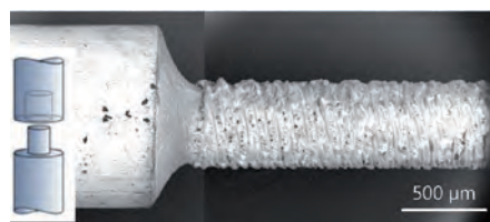
Zapfengeometrie zur Erzeugung einer Verbindung zwischen den Enden zweier Nitinoldrähte (Bild: Dr. Martin)
