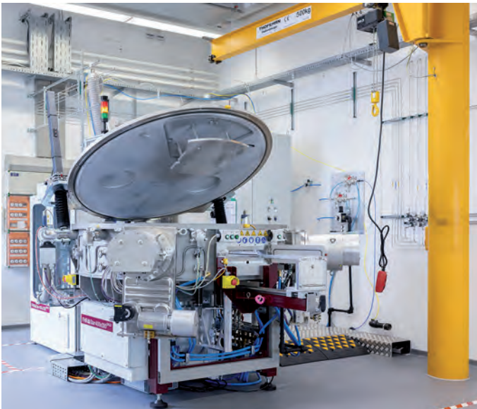
Anlage für multifunktionale und smarte Oberflächenveredelungen, beispielsweise für optische Funktionen oder zur Erzielung von Antihaf-beziehungswise antibakteriellen Eigenschaften. Auch Dünnschicht-sensorik kann aufgebracht werden (© Fraunhofer IST)
