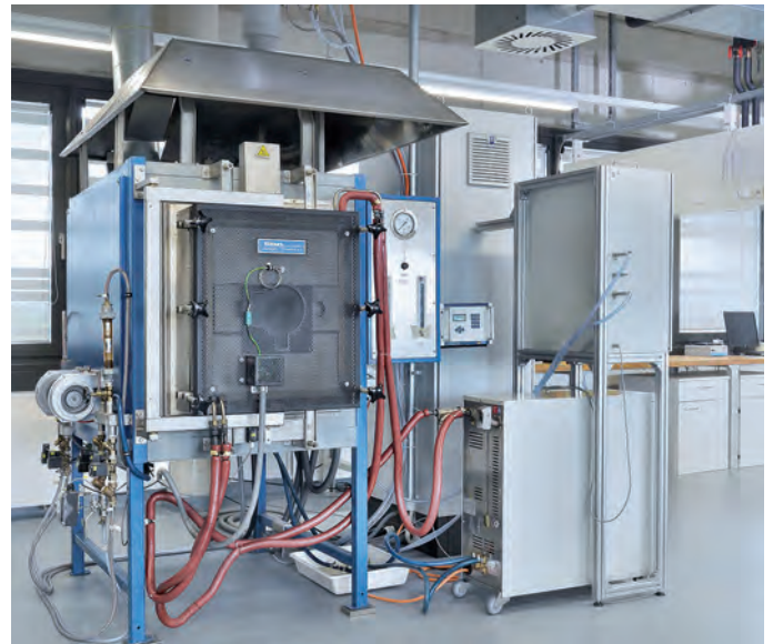
Pyrolyseofen des Fraunhofer IGCV zur Untersuchung des Recyclings faserverstärkter Kunststoffe (Separation von Fasern und Matrix mittels Pyrolyse); kreislaufwirtschaftliche Ansätze spielen für die Akzeptanz von Composites eine wachsende Rolle (© Fraunhofer IGCV / Thomas L. Fischer)
