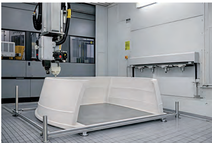
Großformatiger 3D-Druck im vom BMW geförderten Projekt 3D-FiberTrain : Druck der Bugnase eines Hochgeschwindigkeitszuges
