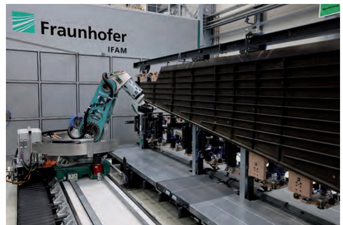
Leichtbau für großvolumige Bauteile: Die neu entwickelte flexible Fräskinematik auf einer Linearachse bearbeitet ein CFK-Flugzeugseitenleitwerk im Maßstab 1:1 mit hoher Präzision
