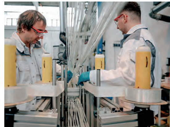
Pultrusion: lange, leichte und zugleich hochfeste Faserverbundprofile (Bild: IWU)
