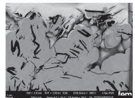
Verteilung des Graphits in der Zinn-Nickel-Schicht (Bild: M. Schwöd)
