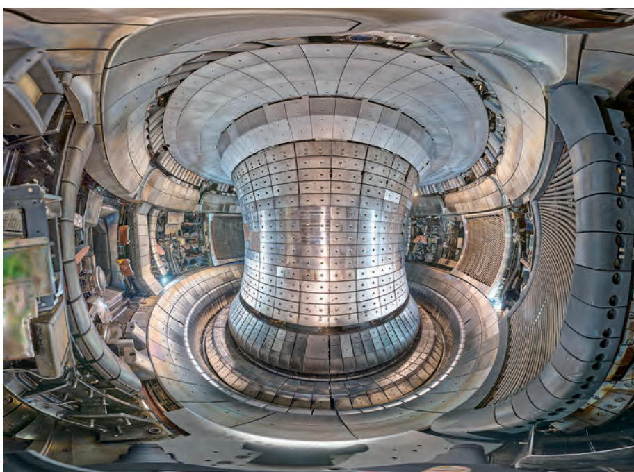
Das mit Wolfram-beschichteten Ziegeln ausgestattete Plasmagefäß des ASDEX-Upgrades am MPI für Plasmaphysik in Garching bei München (Bild: MPI für Plasmaphysik / V. Rohde)
