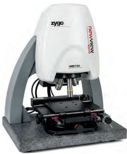
Abb. 2: Weißlichtinterferometer zur optischen Rauheitsmessung
