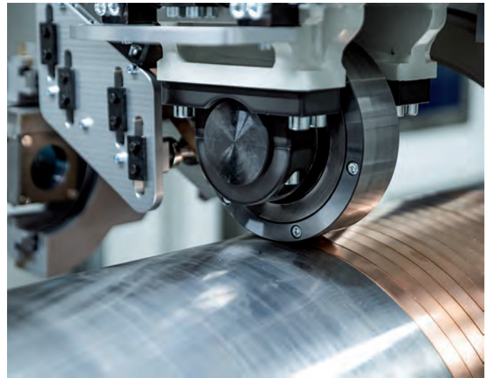
Das Laserdirektplattieren erzeugt eine funktionale Schicht direkt auf dem Grundkörper, indem ein bandförmiges Metall spiralförmig auf rotationssymmetrische Bauteile aufgebracht und lokal per Laser stoffschlüssig verbunden wird (Bild: Ch. Wilsnack/Fraunhofer IWS)
