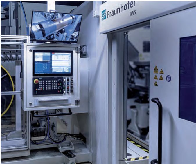
Das Fraunhofer IWS hat das Laserdirektplattieren zum Patent angemeldet und eine Pilotanlage für Bauteile bis zwei Meter Länge aufgebaut, die den Prozess vollständig kapselt (Bild: Ch. Wilsnack/Fraunhofer IWS)
