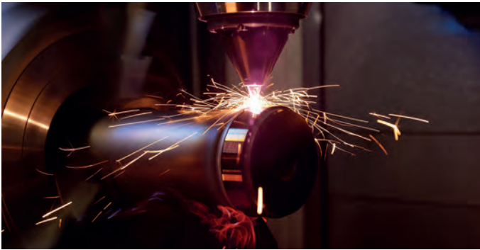
Das SMaC-Verfahren kombiniert EHLA-Beschichtung mit mechanischer Bearbeitung, so wird die Herstellung von Korrosions- und Verschleißschutzbeschichtungen sowie funktionalen Oberflächen beschleunigt: EHLA auf der Oberseite, mechanische Bearbeitung auf der Unterseite (© Fraunhofer ILT)
