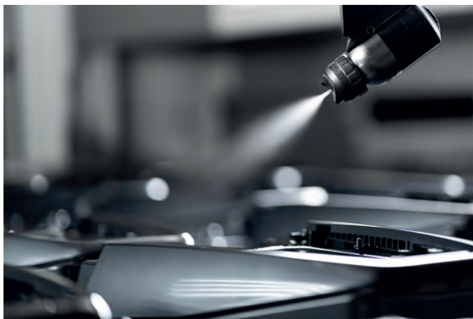
Bei der Lackierung von Interieurkomponenten für so genannte A-Bereiche sind saubere Oberflächen ein Muss, da selbst kleinste Staubpartikel und Fasern Oberflächenirritationen verursachen (Bild: KTX GmbH)
