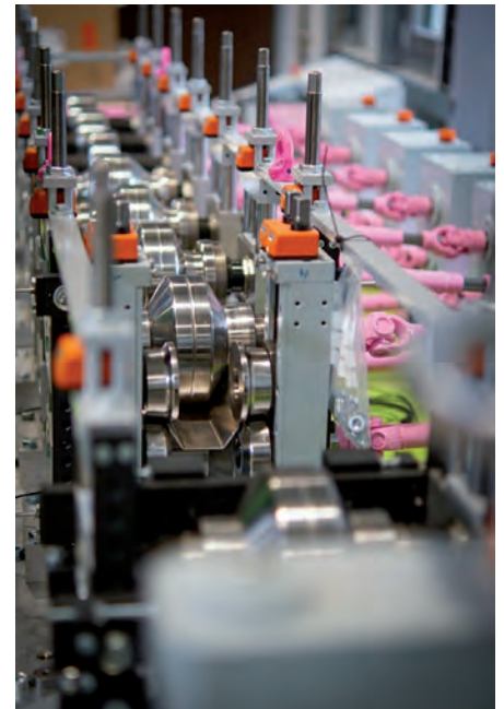
Magnesiumblech bei der Umformung (Bild: TU Bergakademie Freiberg)
