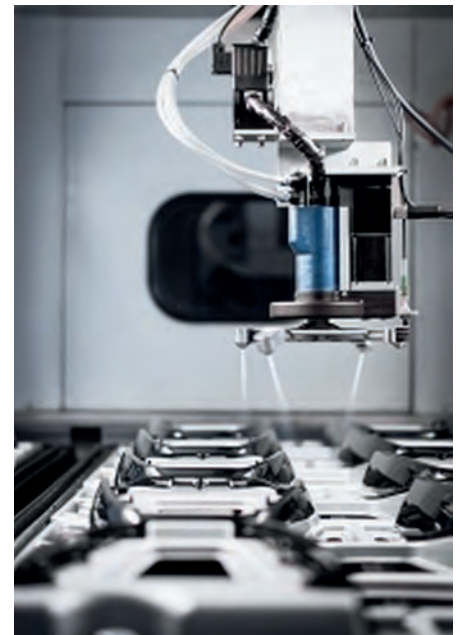
Die neue Reinigungslösung mit Rotationsdüsen sorgt sowohl aus technischer als auch kaufmännischer Sicht für einen Mehrwert (Bild: KTX GmbH)
