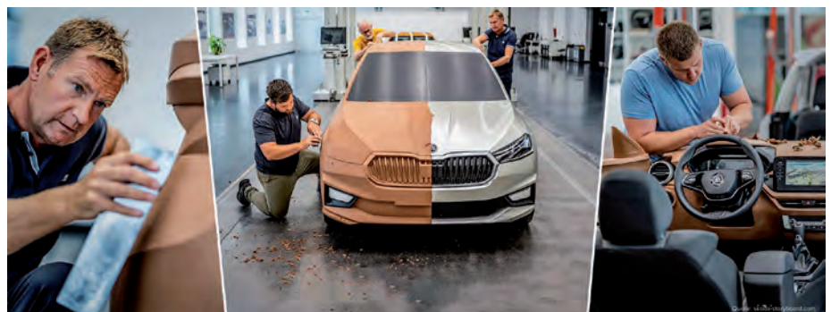
Der Prozess der Designentwicklung umfasst mehrere Stufen vom ersten physischen Modell bis zur Überführung in die Serie (Bild: Prof. Laas)
