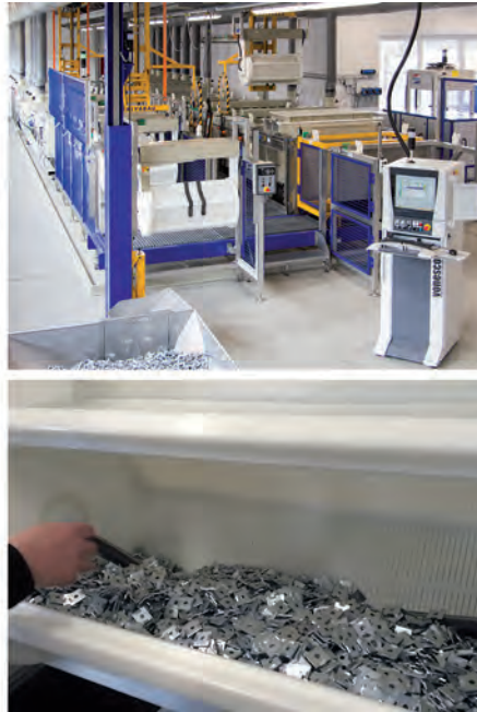
Für die Oberflächentechnik kommt die Gestelltrocknung (links) ebenso wie die Trommeltrocknung (rechts) zum Einsatz
