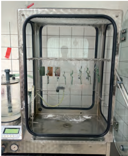
Abb. 2: Salzsprühnebelschrank mit Winkelblechen
