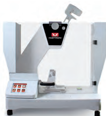
Gerät zur Schlagpendelprüfung (links), ausgestattet mit Software für das Auslesen der erhaltenen Messwerte (Bild: Instron)
