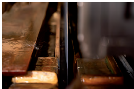
Im Herzen der Bandgalvanik: Ein Stahlband durchläuft eine Verzinkungszelle (Bild: Salzgitter AG)
