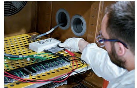
Kontaktieren einer Pouchzelle mit Elektrodenmaterialien aus dem ThüNaBsE-Projekt (© Fraunhofer IKTS)
