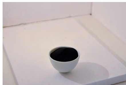
Hard Carbon, gewonnen aus Lignin, einem Nebenprodukt der Holzindustrie, bildet die Basis für die Elektrode der Thüringer Wald-Batterie (© Fraunhofer IKTS)
