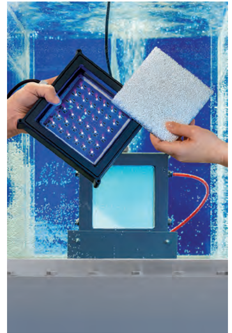
Keramisches Stacksystem mit multifunktionaler Schaumkeramik und LED-Array zur effizienten photokatalytischen Reinigung industrieller Prozess- und Abwässer (© Fraunhofer IKTS)
