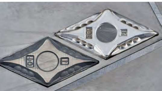
In der neuentwickelten Prozesskette strukturiert ein UKP-Laser Hartstoffbauteile wie dieses Formwerkzeug aus Wolframcarbid-Kobalt, deren strukturierte Oberfläche (l.) anschließend mit demselben Laser poliert wird
