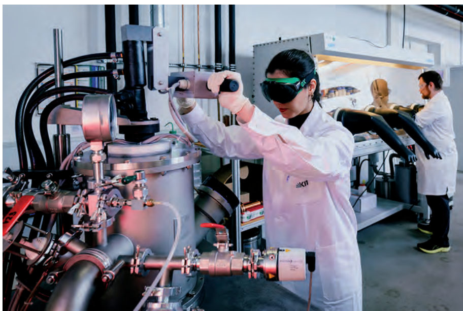
Legierungsherstellung mittels Lichtbogenschmelzen im Materialsyntheselabor des Instituts für Angewandte Materialien – Werkstoffkunde (Bild: Chiara Bellamoli/KIT)
