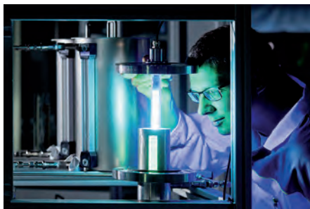
Am Fraunhofer IKTS wird an der Entwicklung multifunktionaler Schaumkeramiken zur photokatalytischen Reinigung gearbeitet (© Fraunhofer IKTS)
