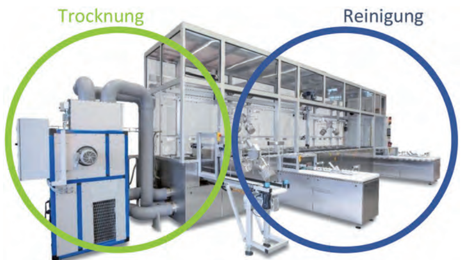
In eine Reinigungsanlage integrierte Kondensationstrocknung mit Arbeitstemperaturen unter 45 °C
