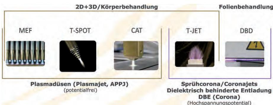
Arten und Ausführungen der verfügbaren Düsen für den Einsatz von Atmosphärendruckplasma
