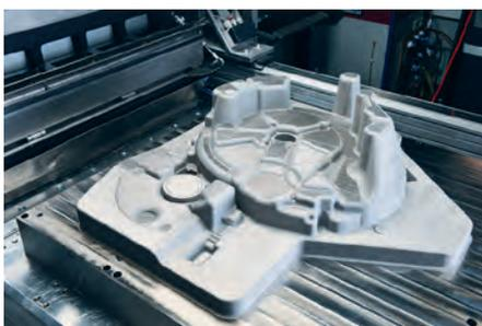
**Additiv gefertigtes Druckguss-Werkzeuginlay aus dem Werkzeugstahl L-40: Die großvolumige Form wurde am Fraunhofer ILT per Laser Powder Bed Fusion hergestellt – mit konturnaher Kühlung** (© Fraunhofer ILT, Aachen)
