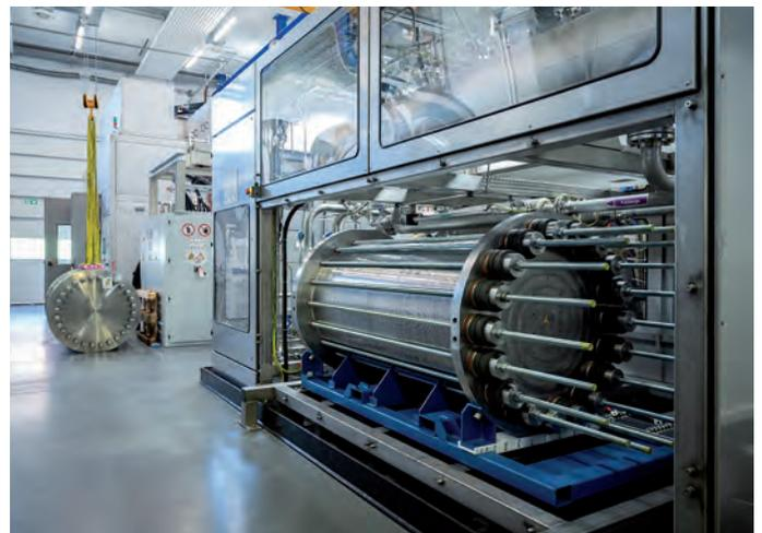
Als Kernkomponente bei der Erzeugung von grünem Wasserstoff beeinflusst der Stack die Effizienz des Gesamtsystems und damit den Preis für das Gas entscheidend (Bild: Ecoclean)
