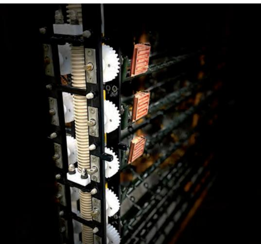
**Der erste Platz beim Oberflächentechnik-Preis DIE OBERFLÄCHE ging 2024 an die Holzapfel Metallveredelung. Ausgezeichnet wurde ein dreh- und kippbares Galvanikgestell (Bild: Holzapfel Metallveredelung)**
