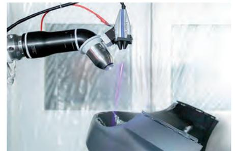
**Lackierversuch am IPA: Ein Roboter sprüht Lack auf einen Stoßfänger und ein Inline-Laserdetektor sowie weitere Sensoren zeichnen alles auf. Mit den Daten wird eine Künstliche Intelligenz trainiert (Fraunhofer IPA / R. Bez)**
