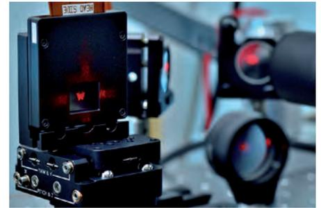
**Mit dem Verfahren des optischen Stempeln lässt sich der Strahl eines Ultrakurzpulslasers exakt in das gewünschte Muster bringen – wie zum Beispiel ein Schmetterling in diesem Bild. So entstehen Mikrostrukturen präzise, reproduzierbar und in einem Bruchteil der bisherigen Zeit** (© Fraunhofer ILT, Aachen)
