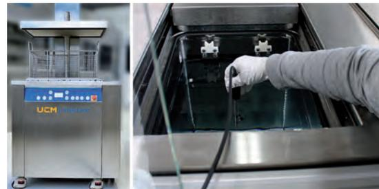
Der Einsatz der APM-Technologie wird an der modularen Ultraschallreinigungsanlage UCMCombiLine für Handarbeitsplätze live demonstriert (Bild: Ecoclean)
