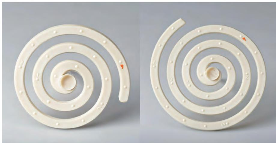
**Verbesserung der Fließfähigkeit durch geeigneten Polymerblend am Beispiel hochgefüllter wärmeleitender Compounds; der Spiraltest zeigt rechts eine deutlich erhöhte Fließlänge gegenüber einem kommerziell verfügbaren Compound (Bild: Fraunhofer LBF)**
