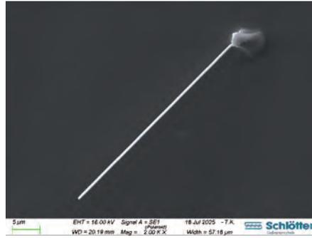
**Bildung von Zink-Whiskern auf galvanisch abgeschiedenem Zink, durch die die Korrosionsbeständigkeit der Schichten verschlechtert werden kann**
