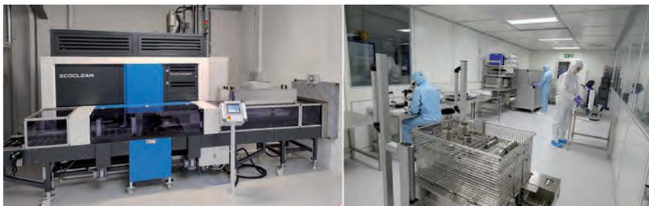
Bauteilreinigung als Dienstleistung ist ebenfalls ein Thema des Messeauftritts. Das Lohnreinigungsangebot reicht von der Grob- über die Zwischen- und Präzisionsreinigung. Aufgaben in der Feinst- und High Purity-Reinigung werden im High Purity-Test Center mit validiertem Reinraum durchgeführt (Bild: Ecoclean)
