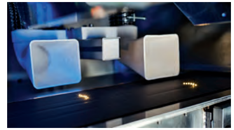
12 von 24 Teilstrahlen im Einsatz: Die Optik von Pulsar Photonics strukturiert das 300 mm breite Band der Batterieanode und verbessert so Leistungsdichte und Ladefähigkeit (© Pulsar Photonics GmbH)
