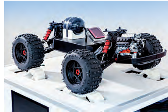
Ein Fahrzeug mit Tank, Brennstoffzellen, Wasserstoffverbrenner und integrierter Sensorik demonstriert die Belastungen und Ansprüche an die Zuverlässigkeit von Wasserstoffsystemen im Einsatz (Bild: Fraunhofer LBF)
