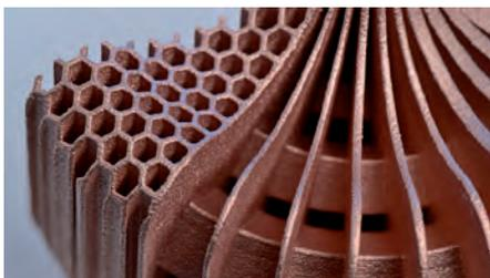
**Die Luft- und Raumfahrt gehört zu den Profiteuren der aktuellen Entwicklung im metallischen 3D-Druck. Kleine Stückzahlen und hohe Komplexität leichter, leistungsfähiger Komponenten gehören schon heute zu den Stärken der Additiven Fertigung (© Fraunhofer ILT)**
