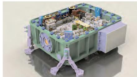
**Das LIDAR-System für die MERLIN-Mission enthält alle Komponenten vom Pumplaser bis zur Frequenzkonversion in einem besonders kompakten und weltraumtauglichen Aufbau**
