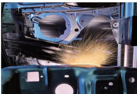
**Laserauftragschweißen als flexible und schnelle Alternative zu Umformen, Schweißen und mechanischer Bearbeitung**
