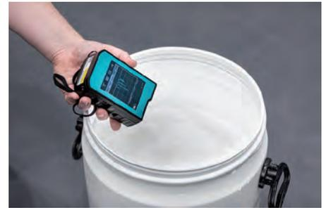
**Wird das mobile Ramanspektrometer auf das Kunststoffpulver gerichtet, zeigt das Display des Messgeräts eine Kurve an, die Rückschlüsse über den Zustand des Pulvers zulässt**
