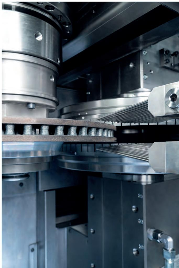
**UGrind 800DD V4 – die neue Generation der Bremsscheiben-Schleifmaschine mit zwei Werkstück- und Werkzeugspindeln für höhere Geschwindigkeit und Präzision**
