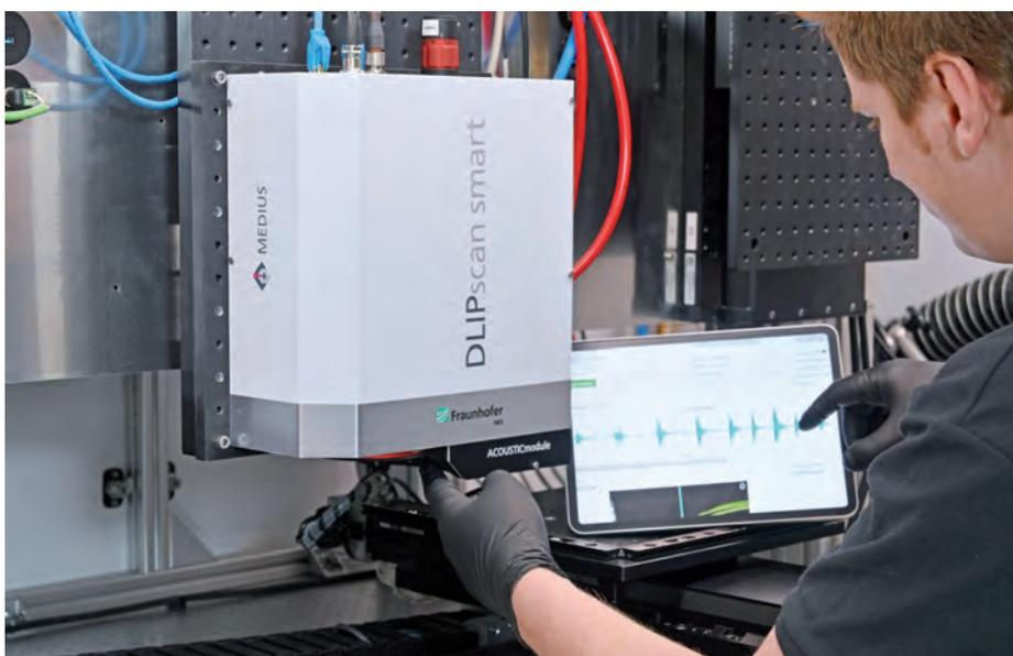
**Das Fraunhofer IWS entwickelt akustische Überwachungslösungen, die Laserprozesse in Echtzeit bewerten, für eine wirtschaftliche und robuste Prozesskontrolle, die Abweichungen sofort erkennt** (© Fraunhofer IWS)
