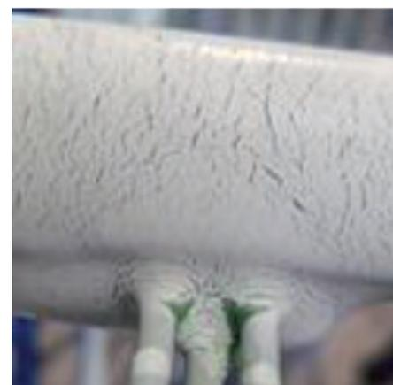
Sichtbare Rissbildung in der Gestellisolierung bei Einsatz eines Standardprodukts
