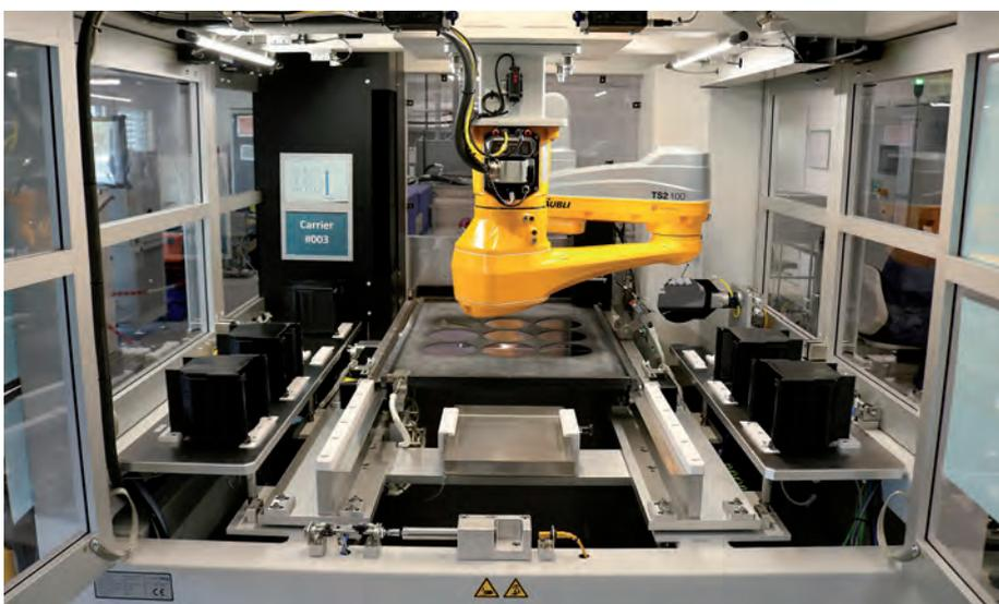
**14** Präzises Handling von Wafern zur Beschichtung mittels PVD-Technik
