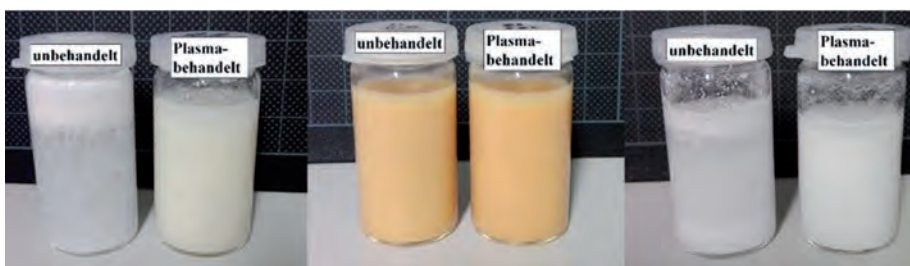
Dispersionen von 10 g/l PEEK (I.), 10 g/l PI (mattig) und 30 g/l hBN (r.) in Wasser, Bilder aufgenommen zwei Minuten nach der Zugabe der Pulver (Bild: Innovent)
