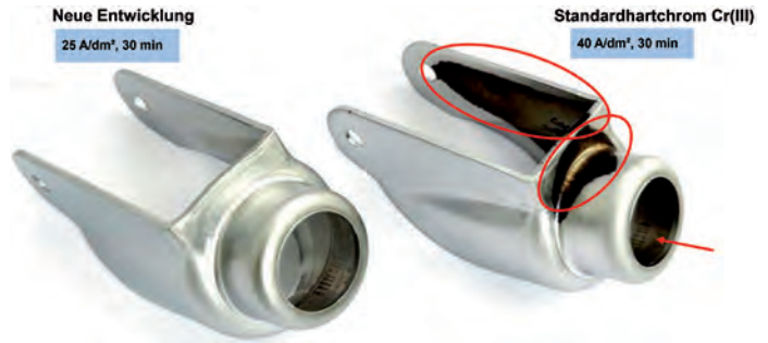
Neue Elektrolyte auf Basis von Chrom(III) zur Abscheidung von Hartchrom zeigen eine deutlich verbesserte Streufähigkeit (Bild: O. Daub)
