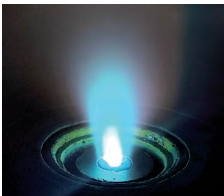
Verdampfung von Cäsiumjodid mit dem anodischen Bogen (© Fraunhofer FEP)
