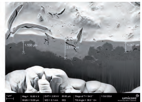
Querschliff durch eine funktionstüchtige MMO-Schicht (r.) sowie fehlerhafte Schicht durch Oxidbildung auf Titan (Bild: Ch. Kurrle)
