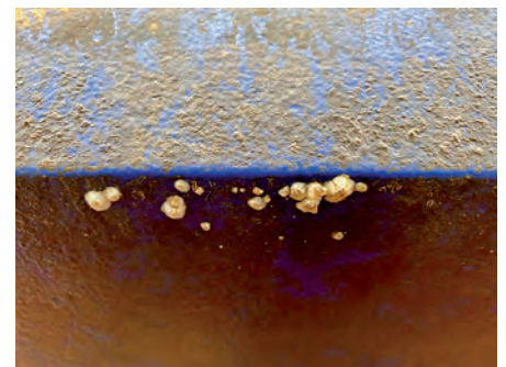
Schiffsrumpf im Dock: Vereinzelte Seepocken und getrockneter Biofilm – typische Spuren des maritimen Bewuchses (© Fraunhofer IFAM)
