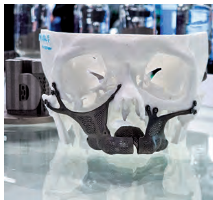
Beispiel der Legierung AMtrinsic®, bestehend aus Titan, Niobium und Tantal, in einem CMF-Implantat
