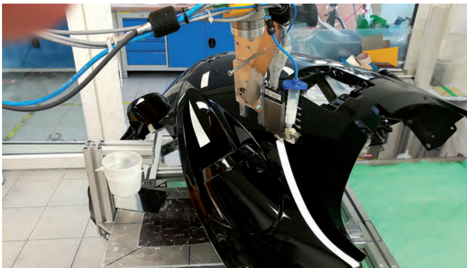
20 Einsparung von Maskierungen bei der Lackierung von Fahrzeugteilen
