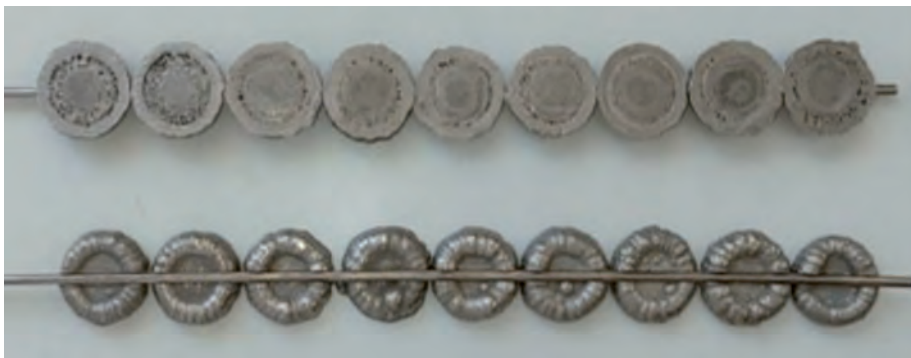
26 Reduzierte innere Spannungen von Nickelschichten durch Anodenoptimierung
