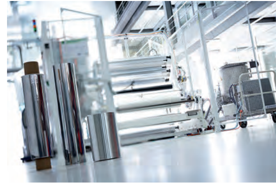
Rolle-zu-Rolle-Pilotbandbeschichtungsanlage atmoFlex 1250 mit 1200-mm-Beschichtungsbreite für die Rolle-zu-Rolle-Nano-Imprint-Lithografie (RzR-NIL-Prozess)
