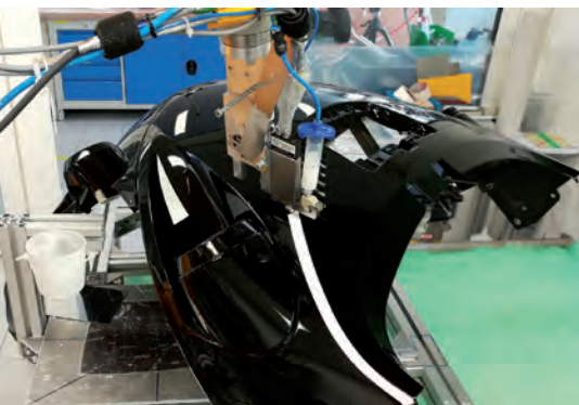
Abb. 1: Maskierungsfreie Dekoration auf einem Fahrzeugteil (Bild: Fraunhofer IPA)
