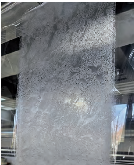
Haptische Oberfläche auf einer Polymerfolie, erzeugt mittels RzR-NIL, die in Kombination mit einem Dekor innerhalb Design-PV als Verkleidung von BIPV-Modulen für Fassaden eingesetzt wird (© Fraunhofer FEP)
