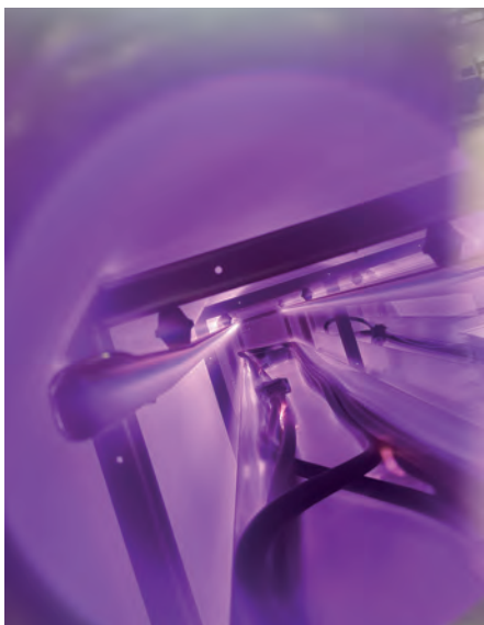
Durch das Plasmaverfahren werden neben verbliebenen oberflächlichen Fertigungshilfsmitteln je nach Materialzusammensetzung auch diffundierte, ungebundene Mischungsbestandteile wie Weichmacher aus Elastomeren herausgelöst (Bild OVE Plasmatec)
