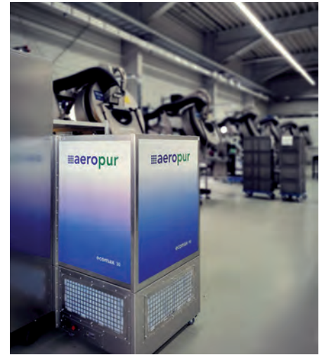
Staubfilter an Fenstern und Aeropur-Luftreiniger sorgen für hochsaubere Produktionsbedingungen ohne Reinraumtechnologie (Bild: OVE Plasmatec)
