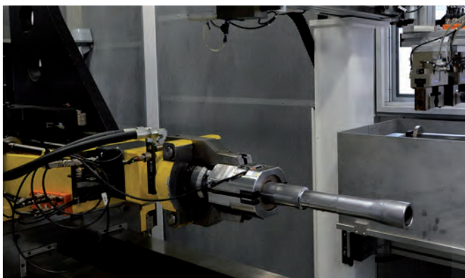
Abb. 2: Das Energieeinsparpotenzial durch Digitalisierung ist beim Rundkneten mit bis zu 70 % besonders hoch (Bild: Fraunhofer IWU)
