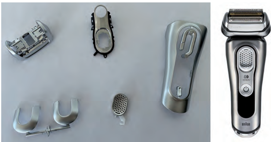
Abb. 1: Kunststoffteile für Rasierapparate werden bei 60 °C innerhalb von elf Minuten vollständig und schonend getrocknet
