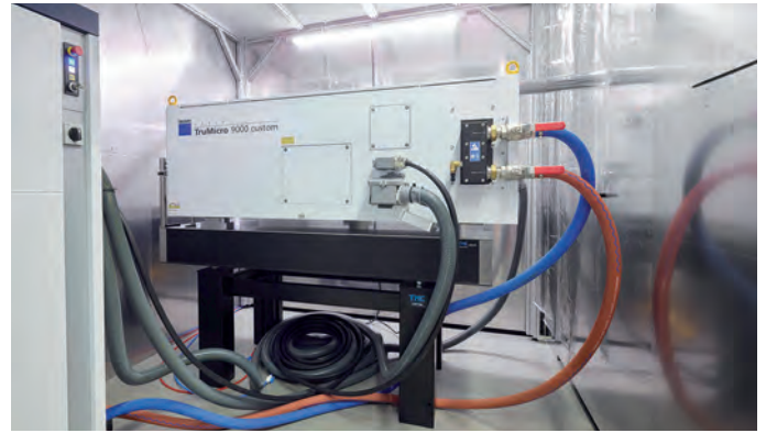
Der industrielle 1kW-UKP-Laser Trumpf TruMicro 9000 in der User-Facility des Fraunhofer Clusters of Excellence Advanced Photon Sources CAPS im ILT in Aachen (© ILT, Aachen/Ralf Baumgarten)
