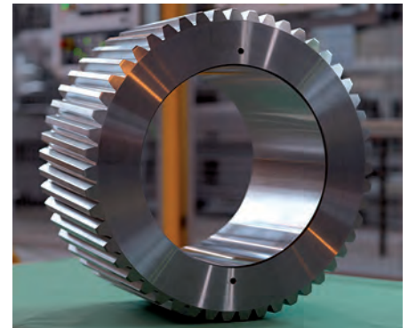
Getriebschäden an Offshore-Windkraftanlagen sind teuer – der Einsatz besonders standfester Zahnräder wie es in GEARFORM entwickelt wurde, zahlt sich aus (© Fraunhofer IWU)
