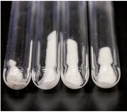
Proben des neuen Festelektrolyten, der von den KI- und HPC-Tools von Microsoft entdeckt wurde; Festkörperelektrolyte werden als sicherer im Vergleich zu flüssigen eingestuft (Bild: Dan DeLong/Microsoft)
