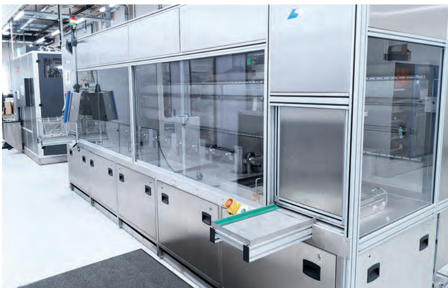
6-Kammer-Reinigungsanlage für wässrige Ultraschallreinigung am Fraunhofer FEP
