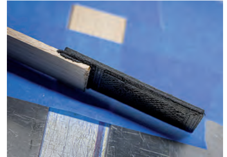
AddJoining nutzt 3D-Druck, um ein Bauteil aus Kunststoff-Verbundwerkstoffen auf Holz aufzudrucken (Bild: Wolf/TU Graz)
