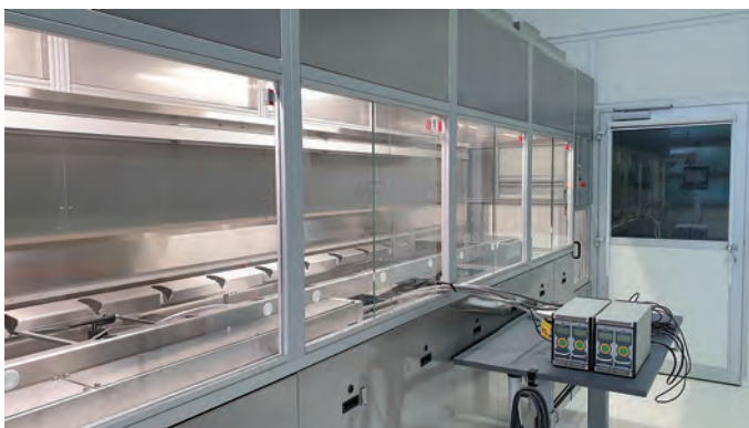
Die Durchführung der Untersuchungen erfolgte in einer Mehrbadtauchanlage mit 500- und 1000-kHz-Ultraschallsystemen (Bild: Ecoclean)
