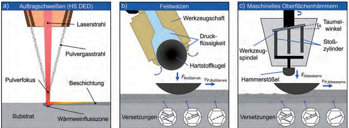
Abb. 1: Verfahren der hybriden Prozesskette aus a) Auftragschweißen (HS DED), b) Festwalzen und c) maschinellm Oberflächenhämmern (MOH)
