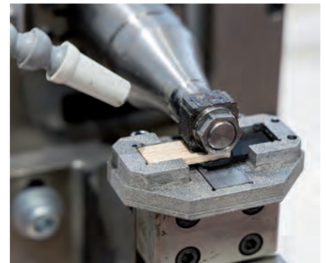
Beim Ultraschallfügen verbinden sich Holz und Grundbauteil durch Reibungshitze (Bild: Wolf/TU Graz)
