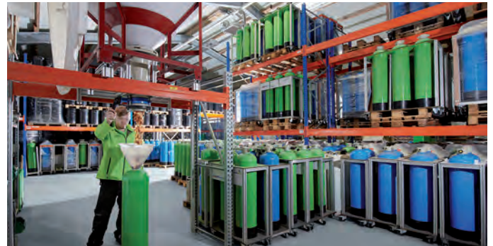
Befüllung von EnviroFALK-Patronensystemen mit speziellen Ionenaustauscherharzen (Bild: EnviroFALK)
