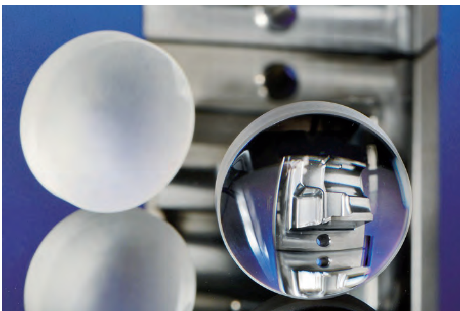
Linse aus Quarzglas geschliffen (l.) und laserpoliert (r.); durch die laserpolierte Linse ist ein laserpoliertes Bauteil aus Werkzeugstahl zu sehen (© Fraunhofer ILT, Aachen)
