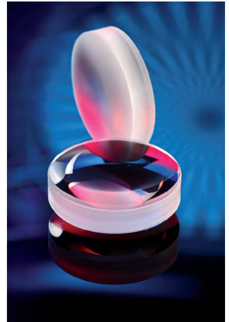
An den Oberflächen der geschliffenen Asphäre hinten streut das Licht. Vorne ist die gleiche Optik im laserpolierten Zustand zu sehen (© Fraunhofer ILT, Aachen)
