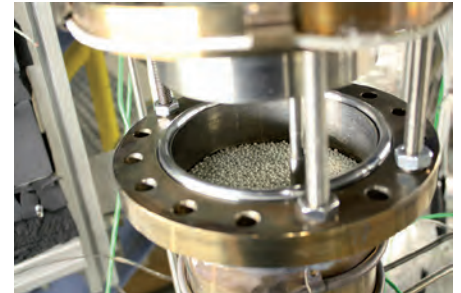
Hier im Labormaßstab – Wärmespeicherung mit Keramik-Kügelchen (Bild: KALLA, KIT)
