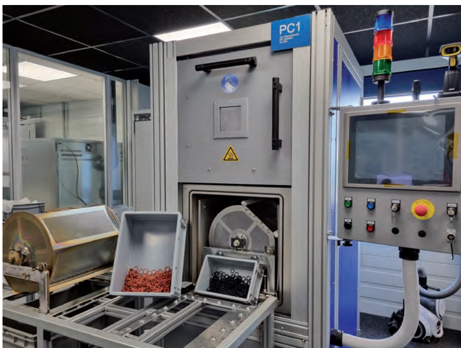
Mit der neuen Plasmabeschichtung entstehen bei OVE Plasmatec beispielsweise hydrophile oder hydrophobe Oberflächen (© OVE Plasmatec)
