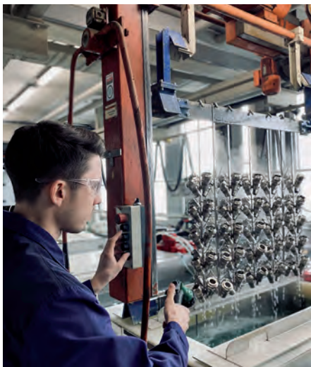
Bauteile werden auf Galvanikgestellen durch den Beschichtungsprozess befördert (Bild: Betz-Chrom)
