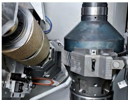
**Wälzschleifen eines Abtriebszahnrad für einen E-Antrieb mit abrichtfreiem CBN; abrichtfreie CBN-Schleifschnecken der Liebherr-Verzahntechnik bieten eine hohe Prozessstabilität durch lange Werkzeugstandzeiten, Vermeidung von Fehlerquellen beim Abrichten, einfaches Werkzeughandling sowie deutlich reduzierten Mess- und Prüfaufwand.**
