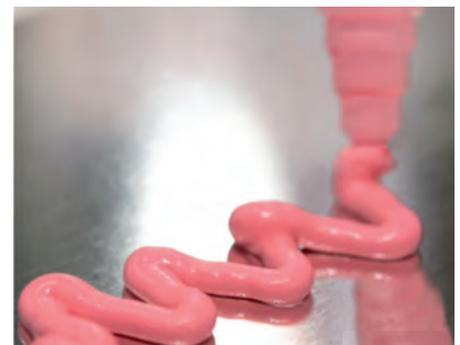
**Abb. 38: Auftragen einer TIM-Paste (Bild: MacDermidAlpha)**
