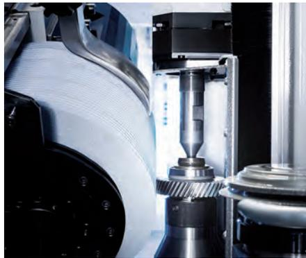
**Durch besonders präzise Schleiflösungen für den Einsatz in der E-Mobilität werden höchste Oberflächengüten im Mikrometerbereich gewährleistet; sie sorgen dafür, dass an den Verzahnungsbauteilen keine störenden Laufgeräusche entstehen** (Bild: Emag)
