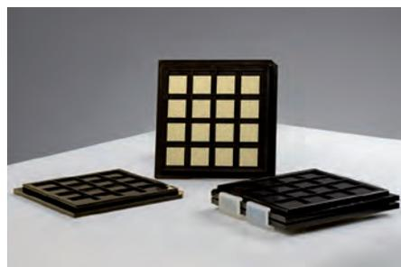
OFET-Substrate des Fraunhofer IPMS im Waffle-Pack © Fraunhofer IPMS
