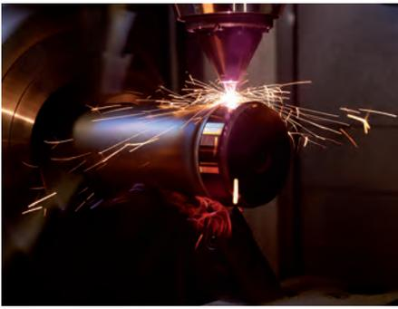
**Abb. 3:** Durch die geringere Härte der Beschichtung aufgrund der hohen Temperatur im Herstellungsprozess wird beim parallelen Beschichten und mechanischen Bearbeiten der Werkzeugverschleiß bei hochfesten Werkstoffen erheblich reduziert
