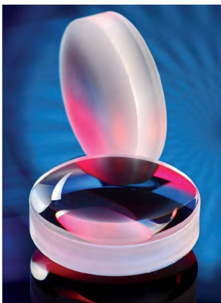
An den Oberflächen der geschliffenen Asphäre hinten streut das Licht. Vorne ist die gleiche Optik im laserpolierten Zustand zu sehen © Fraunhofer ILT, Aachen
