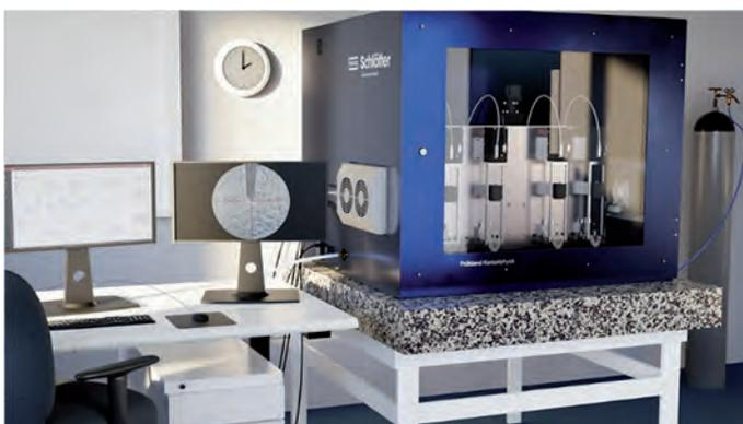
**Abb. 2:** Prüfstand zur Messung der tribologischen und elektrischen Eigenschaften von unterschiedlichen Schichtaufbauten
