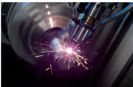
**Abb. 1: EHLA erzeugt im Vergleich zu LMD dünnere Schichten und bietet eine vielfach höhere Beschichtungsrate**
