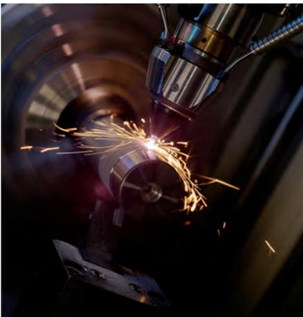
**Abb. 4:** Das Kombinationsverfahren SMAc vereint EHLA mit dem Drehprozess. Die Parallelisierung der beiden Fertigungsprozesse steigert die Produktivität im Vergleich zur konventionellen Prozesskette erheblich
