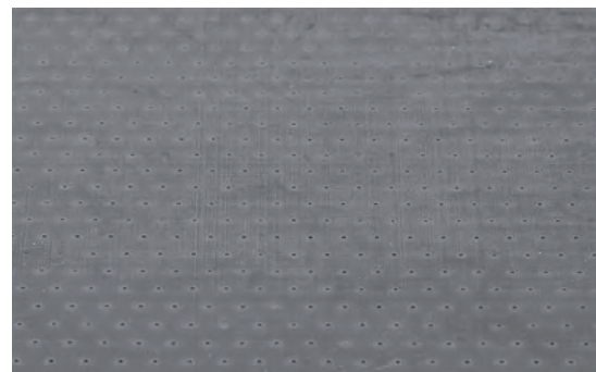
Mikroperforierte Oberfläche des Absaugpaneels (Bild: H. Traub/TU Braunschweig)
