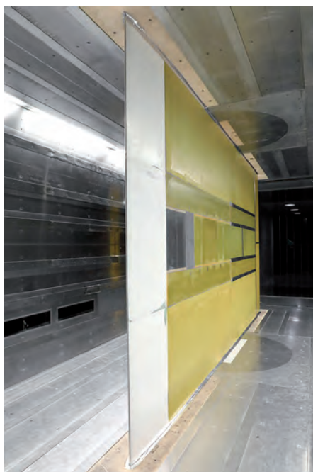
Die ebene Platte in der Messstrecke des Niedergeschwindigkeits-Windkanal Braunschweig mit eingebautem Absaugpaneel (Mitte, grau); hier werden 3D-gedruckte, mikroperforierte Paneele auf ihr Grenzschichtverhalten hin untersucht
