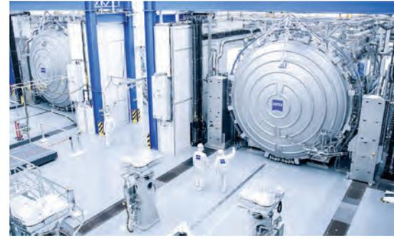
**In riesigen Vakuumkammern mit einem Durchmesser von fünf Metern werden die hochpräzisen Spiegel für die High-NA-EUV-Technologie vermessen** (© ZEISS)
