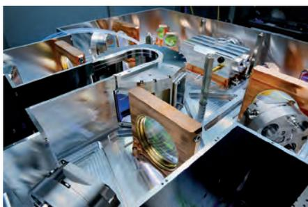
**Mit der Hochleistungsoptik des Fraunhofer ILT werden in Japan Galliumoxid-Kristalle mit einem 20-kW-Diodenlaser hergestellt** (© Fraunhofer ILT, Aachen)
