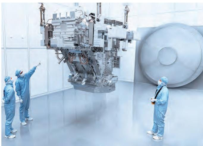
Das ZEISS-Beleuchtungssystem für die High-NA-EUV-Lithographie wiegt ca. 6 Tonnen und besteht aus über 25 000 Einzelteilen (© ZEISS)
