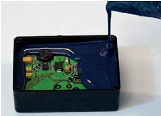
**Abb. 32: Verguss von Leiterplatten und elektronischen Bauteilen (Bild: MacDermidAlpha)**
