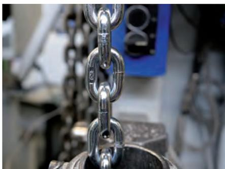
**Im Vergleich zum klassischen Stahlseil punktet die einsatzgehärtete Rundstahlkette mit besonders guter Haltbarkeit (Bild: RUD)**
