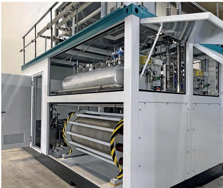
**Die kompakten EcoLyzer erzeugen grünen Wasserstoff auf Basis der ausgereiften alkalischen Elektrolyse. Die modulare Konzeption der Elektrolyseure sorgt dabei für eine wirtschaftliche Fertigung und vergleichsweise kurze Lieferzeiten (Bild: Ecoclean GmbH)**
