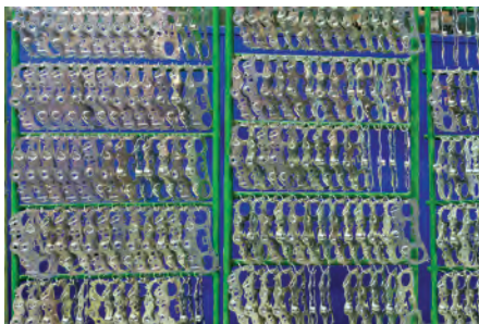
Neben Nickel-Chrom werden weitere Teile galvanisch mit Zink beschichtet
