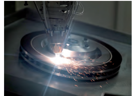
Beim Laserbeschichten von Bremsscheiben wird ein spezielles Metallpulver (häufig mit Karbiden) mit hoher Vorschubgeschwindigkeit und hoher Laserleistung auf die Bremsscheibe aufgetragen (Bild: EMAG)
