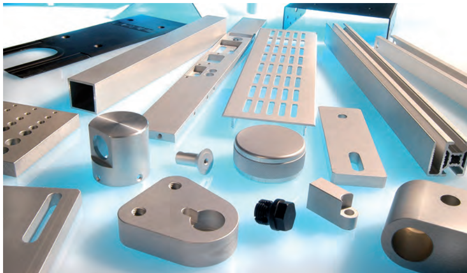
Werkstücke mit unterschiedlichen Wanddicken und komplexen Geometrien erschweren die Nennung der geforderten Richtzahlen (Bild: VOA)
