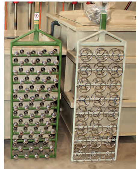
Bestückte Gestelle für Vorversuche zur Trocknung mittels Kondensationstechnik
