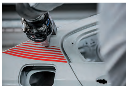
Der erste Platz beim Oberflächentechnik-Preis DIE OBERFLÄCHE 2022 ging an die Dürr Systems AG . Ausgezeichnet wurde eine komplett oversprayfreie Nasslackierung (Bild: Dürr Systems AG)
