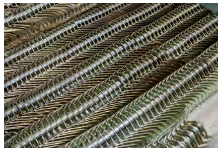
Neben Nickel-Chrom werden weitere Teile galvanisch mit Zink beschichtet
