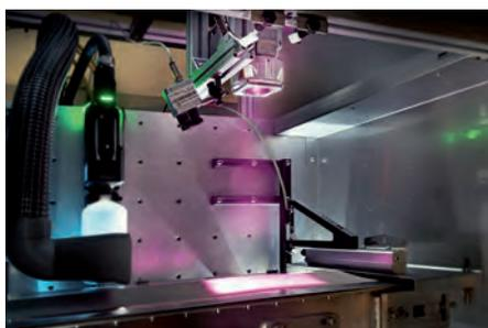
**Trocknung mit Diodenlaser: Dank besonderer Optik erhitzt der Laser eine größere Fläche auf der mit Grafitpaste beschichteten Kupferfolie**
