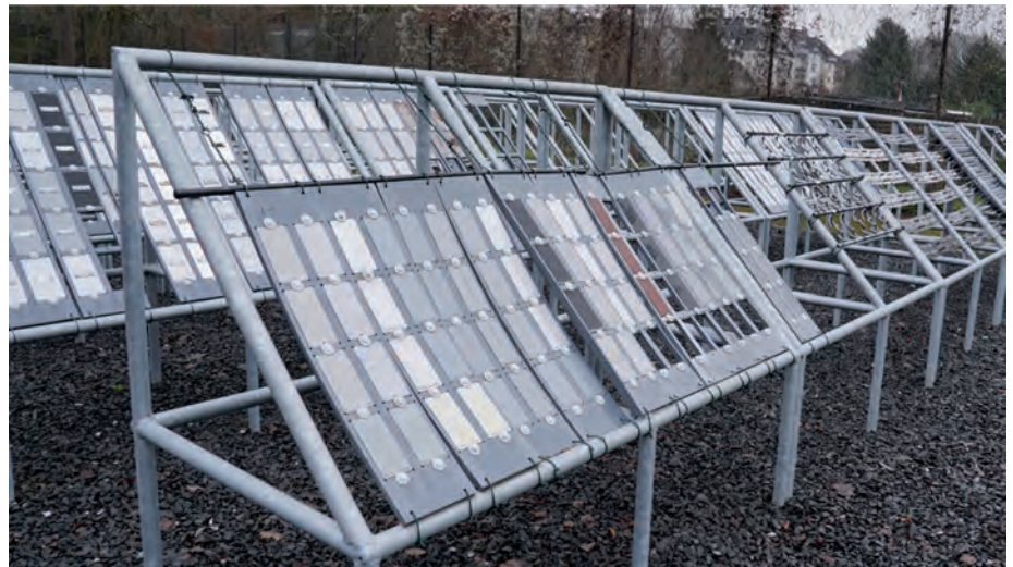
Abb. 3: Der Freibewitterungsstand nahe der Unternehmenszentrale in Herdecke
