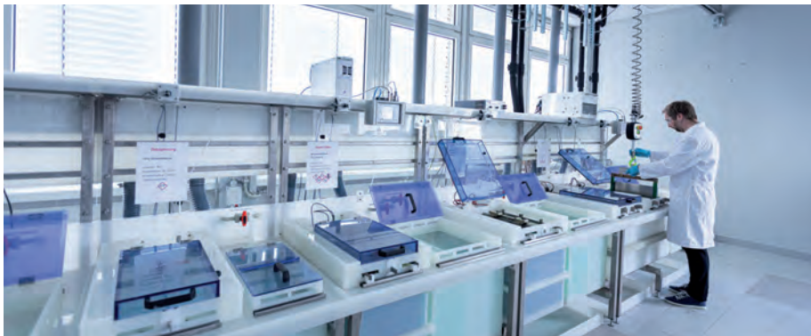
Anlage zur Beschichtung aus dreiwertigen Hartchromelektrolyten mit einem Fassungsvermögen von 400 Litern am Fraunhofer IPA (Bild: Fraunhofer IPA)
