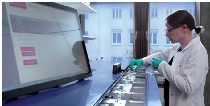
Die Präzisionsmesseinrichtung WSRME TWIN detektiert anhand von C-Ring-Proben Veränderungen im Werkstoffzustand, die zum Beispiel durch Anlass-, Wasserstoff- oder flüssigkeitsmetallinduzierte Versprödung auftreten können (Bild: Dr.-Ing. Max Schlötter)
