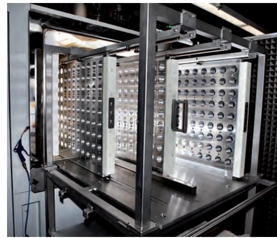
Niederdruckplasmaanlage mit schnell austauschbaren Elektroden systemen, die gleichzeitig als Warenträger fungieren
