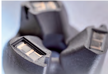
In einem Messerkopf wurden während des Druckprozesses Dehnungsmessstreifen integriert. Der LPBF-Druckprozess wird unterbrochen und die ebenfalls gedruckten Dehnungsmessstreifen eingepasst (links). Der Druckprozess wird anschließend fortgesetzt, um das intelligente Bauteil fertigzustellen (rechts) (© Fraunhofer ILT, Aachen/Volker Lannert)
