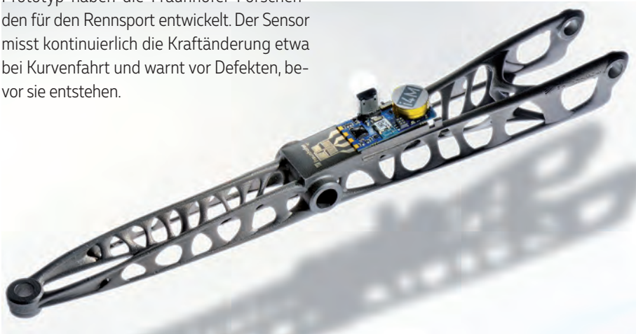
Der Pkw-Querlenker mit aufgedrucktem Kraftsensor liefert zu jedem beliebigen Zeitpunkt die im Einsatz wirkenden Kräfte; er registriert kleinste Risse, die auftreten, bevor ein Defekt entsteht (© Fraunhofer ILT, Aachen)
