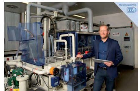
Prof. Dr. Timo Sörgel an der weltweit ersten Technikumsanlage, an der durch eine von ihm entwickelte patentierte Verfahrenskombination Folienverbundmaterial hergestellt werden kann, beispielsweise für Batteriekathoden (Bild: Hochschule Aalen/Volker Miosga)
