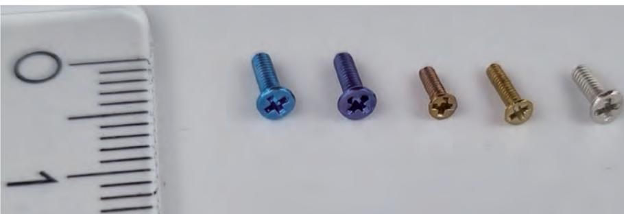
**Abb. 9:** Miniaturschrauben mit verschiedenen Schichtdicken einer ALD-Metalloxidschicht; die rechte Schraube ist unbeschichtet
