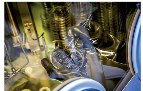
**Organische Solarzellen in einer sogenannten Glovebox, in der sie mit künstlichem Sonnenlicht bestrahlt werden**
