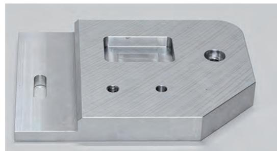
**So sieht das fertige Bauteil aus, wenn die CNC-Maschine die Zeichen interpretiert und das Rohmaterial entsprechend bearbeitet hat (Bild: IPA / Rainer Bez)**
