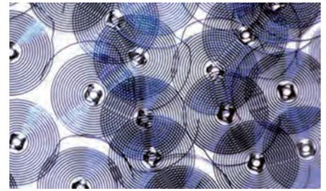
**Abb. 10:** Uhrenfedern mit einem Durchmesser von wenigen Millimetern können als Schüttgut mit ALD-Verfahren homogen blau beschichtet werden; sämtliche Flächen weisen die gleiche Beschichtungsdicke auf
