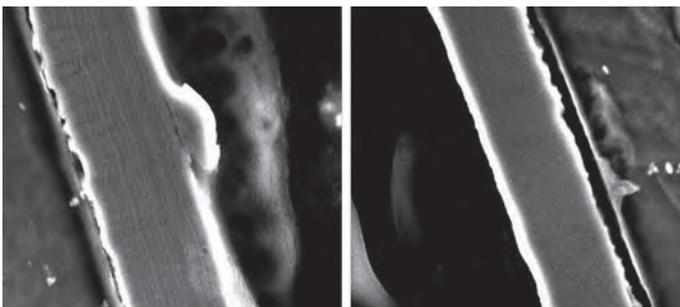
**Je nach Phosphorgehalt in der Nickel-Phosphor-Schicht ändert sich die Struktur der Schicht, links mit 6 % Phosphor, rechts mit 11 % (5000fach) (Bild: S. Habekuß)**
