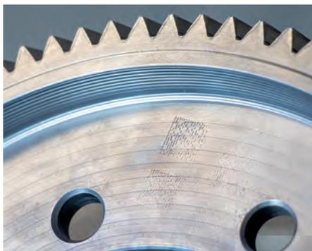
**Gedruckter Data-Matrix-Code auf einem Metallbauteil** (© Senodis Technologies GmbH)
