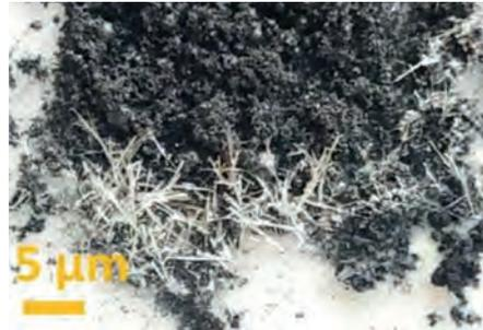
In der Mikrowelle entstehen haarförmige Strukturen aus Molybdänen (rechts)
