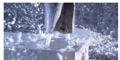
**Kühlschmierstoffversorgung: Ansatzpunkt zur energetischen Optimierung einer Werkzeugmaschine** (Bild: IFW)
