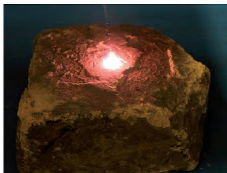
**Gebrauchte Feuerfestmaterialien werden mit Lasermessungen erkannt und CO<sub>2</sub>-sparend wiederverwendet** (© Fraunhofer ILT, Aachen)
