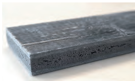
ElroFoam – thermoplastische Sandwichstruktur (© ElringKlinger AG)
