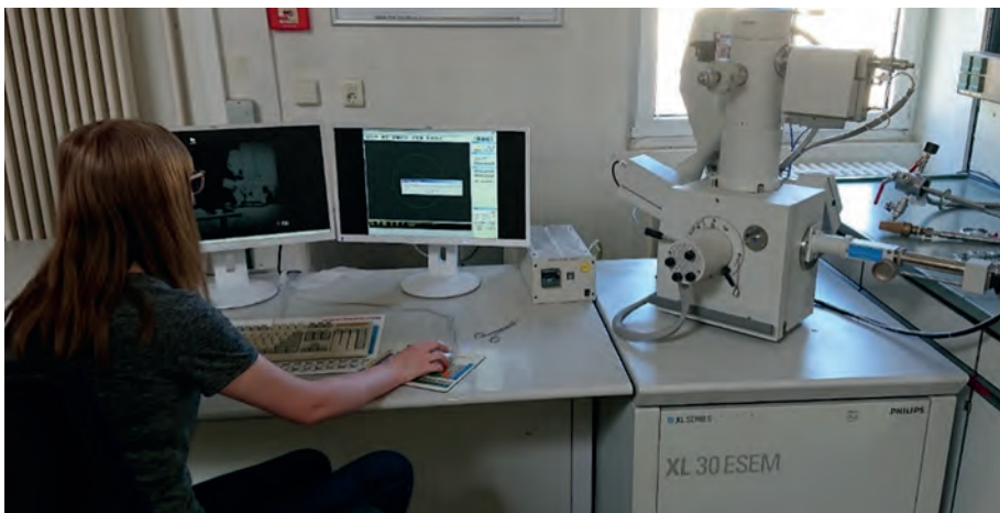
Abb. 10: Rasterelektronenmikroskop (REM) mit EDX-Detektor
