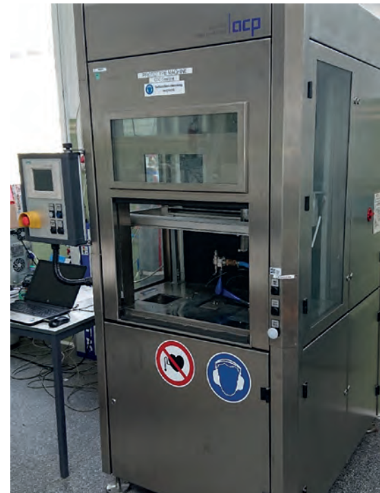
Abb. 4: CO 2 -Schneestrahls-Anlage der acp AG
