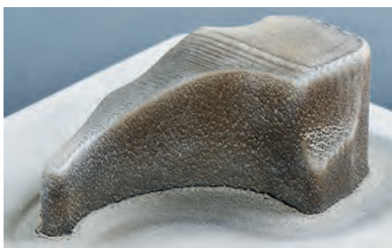
Schnell und präzise: Additiven Fertigung eines Formbauteils mittels EHLA 3D mit deutlich verkürzter Druckzeit im Vergleich zu LMD und LPBF (© Fraunhofer ILT, Aachen)
