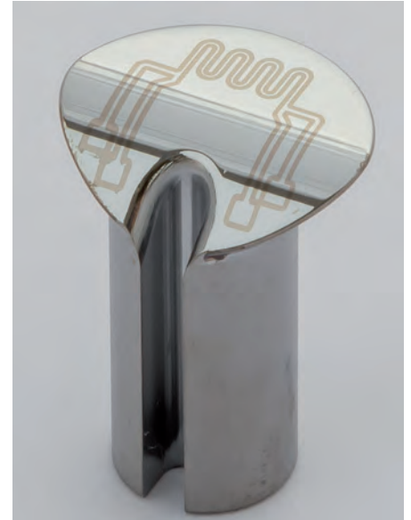
Mit Dünnschichtsensorik beschichteter Sensoreinsatz (© Fraunhofer IST/Ulrike Balhorn)
