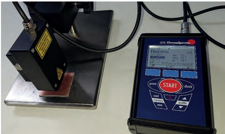
Abb. 9: CleanoSpector-Messgerät zur Bestimmung der Fluoreszenzintensität
