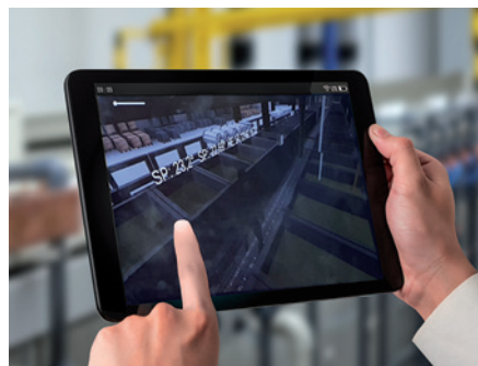
Abb. 5: Augmented Reality: Nach Scannen des Ankerpunkts an der Anlage werden Live-Werte auf der mobilen Anwendung eingeblendet (© B+T Oberflächentechnik GmbH)
