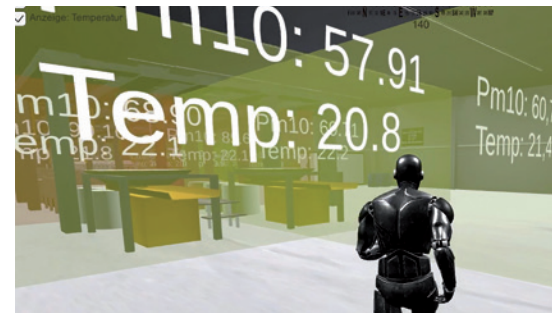
Abb. 1: Digitaler Zwilling einer Prozessanlage mit virtuellem Mitarbeiter
