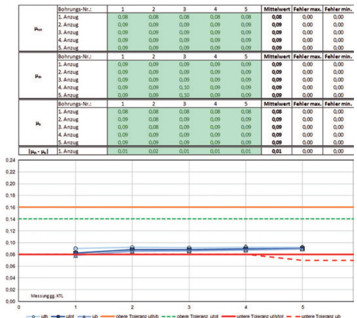
Abb. 9: Zink-Nickel-Beschichtung; M8x35-10.9, Elektrolyt Zinni AL 450, Passivierung Tridur DB, Topcoat Sealer 350 WL8; Verschraubung gegen KTL, Prüfung gemäß MBN 10544
