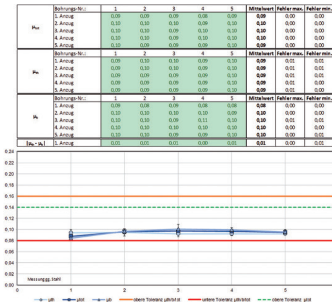
Abb. 7: Zink-Nickel-Beschichtung; M8x35-10.9, Elektrolyt Zinni AL 450, Passivierung Tridur DB, Topcoat Sealer 350 WL8; Verschraubung gegen Stahl, Prüfung gemäß MBN 10544
