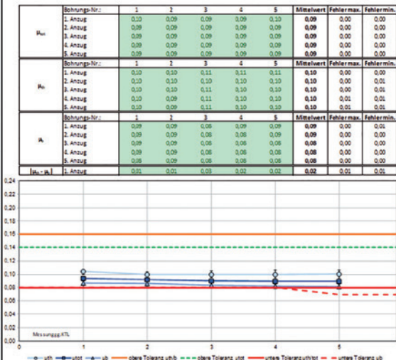
Abb. 12: Zink-Nickel-Beschichtung; M10-10, Elektrolyt Zinni AL 450, Passivierung Pass 1 im Vergleich zu Pass 2, Top-coat Sealer 350 WL8; Verschraubung gegen KTL, Prüfung gemäß MBN 10544
