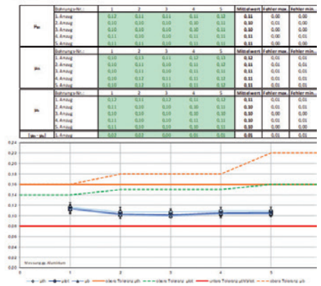
Abb. 5: Zinklamellenbeschichtung; M6x50-10.9, Basecoat Zintek 200, Topcoat Zintek Top LV; Schneller Voranzug / Mehrfachanzug gegen Aluminium, Prüfung gemäß MBN 10544; Hinweis: relevant sind die Werte bei 200 U/min
