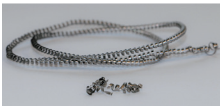
Mit Schwingungsunterstützung erzeugte kurze Späne (Bildvordergrund) im Vergleich zu langen Spänen (konventioneller Drehprozess mit identischen Parametern) (© Fraunhofer IWU)
