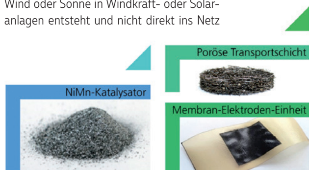
Das Fraunhofer IFAM entwickelt im Projekt HighHy mit deutschen und neuseeländischen Partnern hochaktive Katalysatormaterialien und deren Einbringung in eine Membran-Elektroden-Einheit (© Fraunhofer IFAM Dresden)
