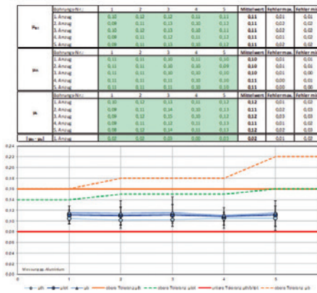
Abb. 5: Zinklamellenbeschichtung; M6x50-10.9, Basecoat Zintek 200, Topcoat Zintek Top LV; Schneller Voranzug / Mehrfachanzug gegen Aluminium, Prüfung gemäß MBN 10544; Hinweis: relevant sind die Werte bei 200 U/min
