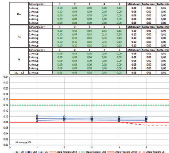
Abb. 12: Zink-Nickel-Beschichtung; M10-10, Elektrolyt Zinni AL 450, Passivierung Pass 1 im Vergleich zu Pass 2, Top-coat Sealer 350 WL8; Verschraubung gegen KTL, Prüfung gemäß MBN 10544
