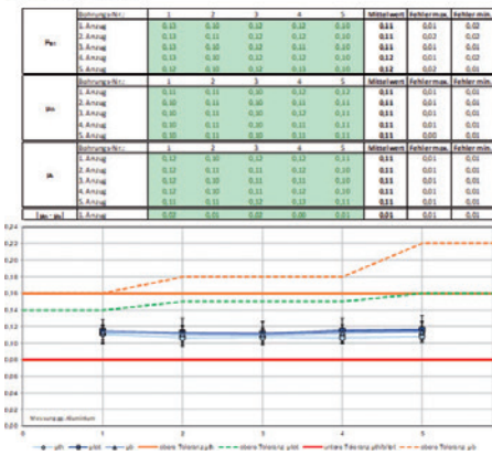
Abb. 5: Zinklamellenbeschichtung; M6x50-10.9, Basecoat Zintek 200, Topcoat Zintek Top LV; Schneller Voranzug / Mehrfachanzug gegen Aluminium, Prüfung gemäß MBN 10544; Hinweis: relevant sind die Werte bei 200 U/min
