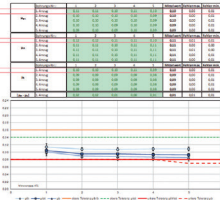
Abb. 6: Zinklamellenbeschichtung; M6x50-10.9, Basecoat Zintek 200, Topcoat Zintek Top LV; Schneller Voranzug / Mehrfachanzug gegen KTL, Prüfung gem. MBN 10544; Hinweis: Eine Forderung bezüglich schnellem Voranzug seitens der MBN 10544 besteht nur gegenüber KTL - und nur einfach!
