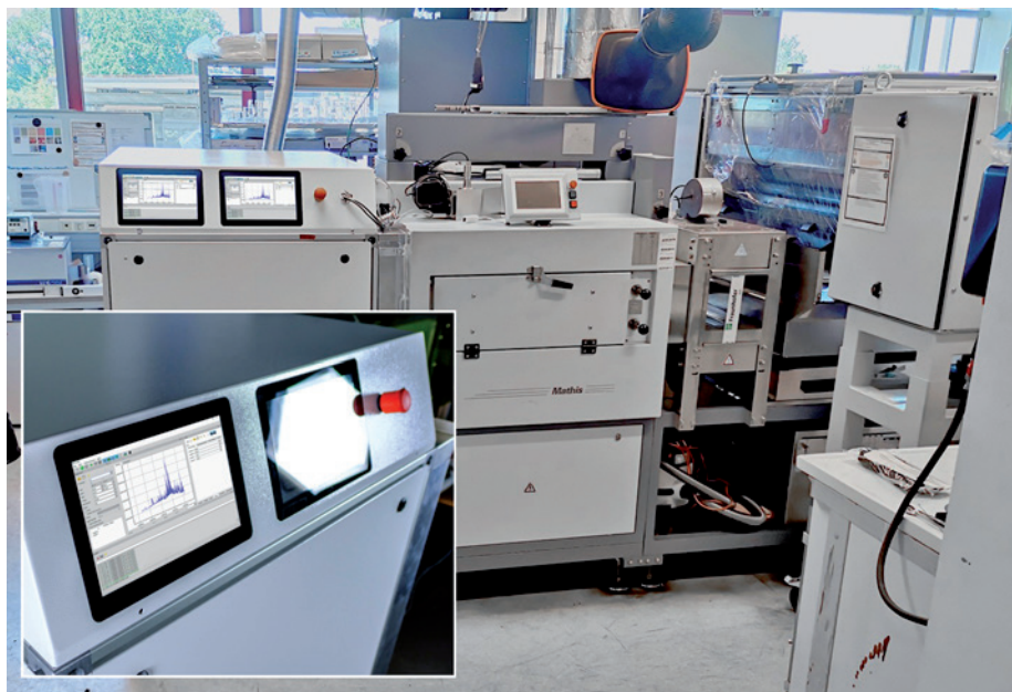
Fraunhofer IPM und Fraunhofer ISIT haben auf Basis der LIBS-Technologie ein Inline-Messsystem entwickelt, mit dem die chemische Zusammensetzung beschichteter Elektrodenfolien punktwise in einer Art 3D-Mapping quantitativ erfasst werden kann (kleines Bild). Das System wurde am ISIT in die Laboranlage einer Elektrodenfertigung integriert und getestet (© Fraunhofer IPM)
