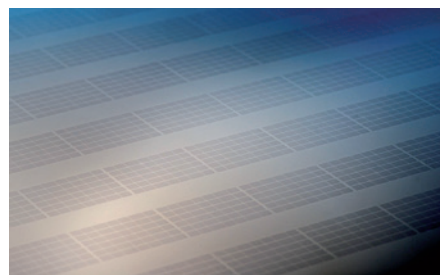
Detailansicht der selektiv laserkristallisierten Siliziumfelder (© Fraunhofer ILT, Aachen)
