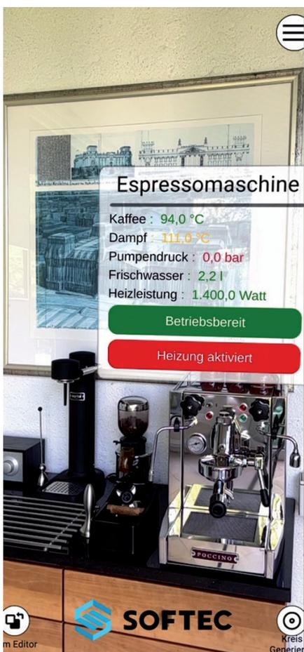
Abb. 5: Die fertige Datentafel zeigt dynamisch verschiedene Werte und warnt per Farbkodierung bei Abweichungen
