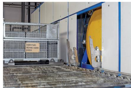
**Die Lohnentfettungsanlage reinigt die Teile der ElringKlinger AG porentief von Öl und anderen Partikeln (Foto: Richard Geiss)**
