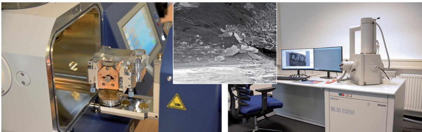
**Analysentechnik in Bestausstattung unterstützt die hohe Qualität der Fertigung und die Beseitigung von Beschichtungsfehlern, wie zum Beispiel abplatzende Schichten**
