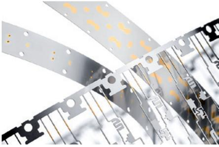
**Die Spottechnik ermöglicht höchste Präzision und kann punktuell auf wichtige Funktionsbereiche eines Bauteils aufgebracht werden**
