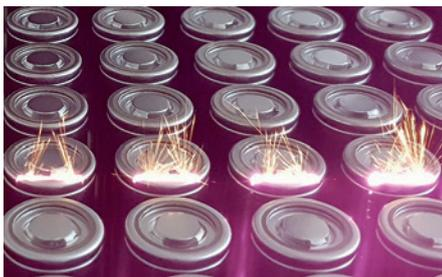
**Reinigung der Oberflächen von Batteriezellen zur Erzeugung eines guten elektrischen Kontakts**
