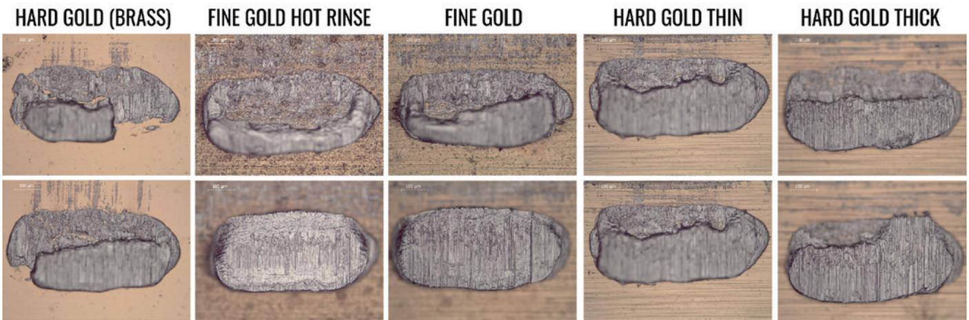
Abb. 11: Bruchbilder nach Schertest
