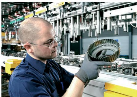
**ElringKlinger produziert dynamische Präzisionssteile wie diesen Lamellenträger, der unter anderem im Getriebe reiner Elektrofahrzeuge zum Einsatz kommt. Zuvor werden sie von Richard Geiss entfettet (Foto: ElringKlinger)**
