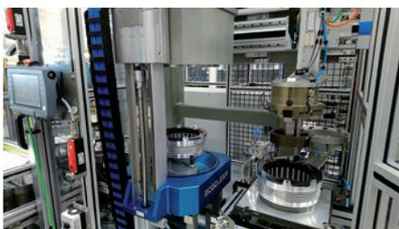
**Um bei der Endmontage von beispielsweise Statorn Verunreinigungen aus Vorprozessen wie metallische und nicht-metallische Partikel zu entfernen, werden trockene Reinigungslösungen wie etwa die Druckluftreinigung eingesetzt (Bild: Ecocean/ZF)**
