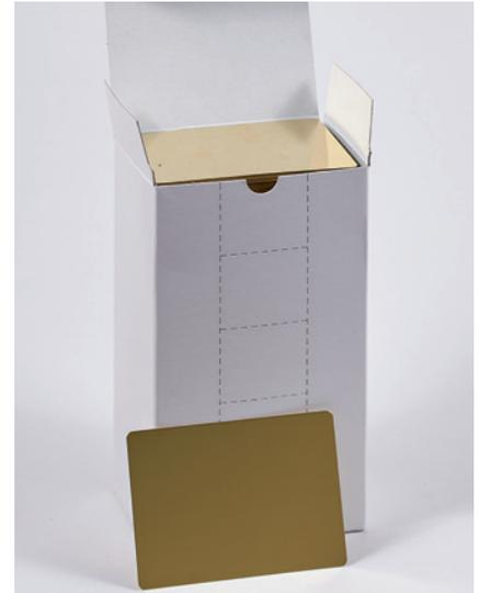
**33** Hull-Zellen für die Galvanik
