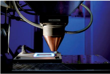
**Das neue Verfahren COLLAR Hybrid Additive Manufacturing setzt auf eine Kombination von Lichtbogen- und Laserauftrag**
