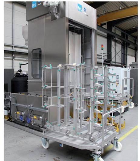
**Für die Reinigung in der Drehtelleranlage werden bis zu 2200 mm lange Karosserieteile, zum Beispiel Strangpressprofile, senkrecht fixiert und exakt auf die zu reinigenden Bereiche positioniert** (Bild: BvL Oberflächentechnik)
