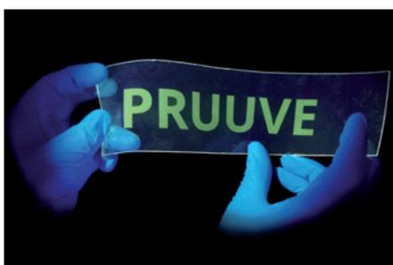
**Aus dem EXIST-Forschungstransfer PRUUE (Phosphorescent Response Under UV Excitation) entstanden wiederverwendbare UV-Sensorfolien und Etiketten** (© Tim Achenbach)
