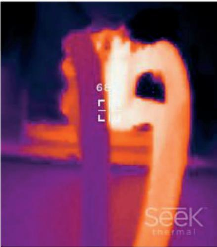
**Wärmebild eines Kontaktblocks an einer Abscheideposition (Bild: Th. Göppfarth)**
