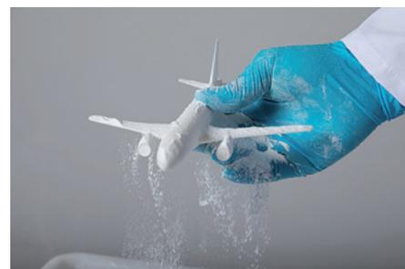
Ein Modellflugzeug, das mit dem selektiven Lasersintern gefertigt wurde, wird aus dem Pulverbett gehoben (Symbolbild)
