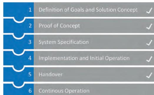
**ML4P-Vorgehensmodell für die Implementierung von Machine-Learning-Methoden in der industriellen Produktion** (© Fraunhofer)
