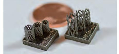
**Prototypen eines vom Lehrstuhl Werkstoffkunde mittels LPBF gefertigten Stents aus einem Eisen-Mangan-Silber-Mischmaterial im Vergleich zu einer 1-Cent-Münze**
