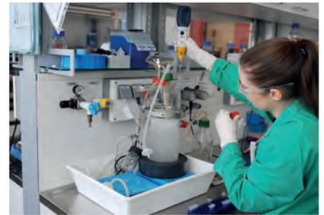
**Mit dem Projekt Bio4Rec schlägt das Helmholtz-Institut Freiberg für Ressourcentechnologie (HIF) am HZDR einen neuen Weg des Recyclings ein: Für die Rückgewinnung der Metalle, aber auch zur Entfernung schädlicher Schwermetalle werden Biomoleküle eingesetzt (Bild: HZDR/Frank Bierstedt)**
