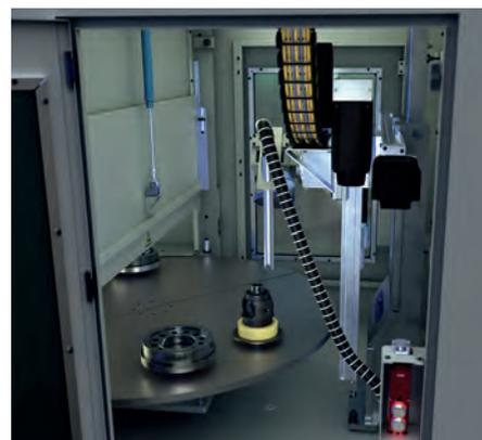
**Der Rundtisch ist getrennt vom Arbeitsbereich und kann per Automation oder per Hand bedient werden (Bild EMAG)**
