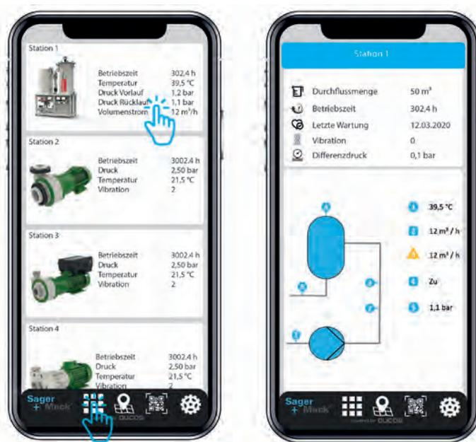
**Zustandsdaten einer Pumpen- und Filterstation sind auf den Mobilgeräten verfügbar**
