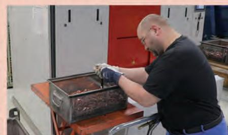
**Nach stichprobenartiger Prüfung der Reinigungsqualität kippert Frank Duve die Kupferschienen in einen Container und transportiert sie zum nächsten Bearbeitungsvorgang**
