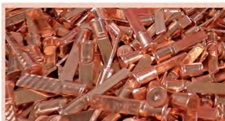
**Mit der Pero S1A befreit SHU die Kupferbauteile von jeglichen Spänen und Fett; zudem sorgt die lösemittelbasierte Reinigungsanlage für eine schnelle Trocknung und ohne Oberflächenkorrosion**
