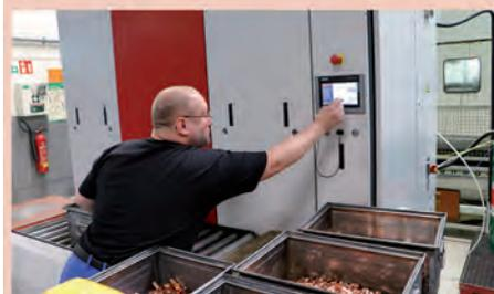
**Einfache Bedienung: SHU-Facharbeiter Duve bringt die zu reinigenden Kupfer Teile in Körben zur Pero S1A, öffnet über das interaktive Bedienerfeld die Luke, stellt das Reinigungsprogramm ein, schiebt den Bauteilkorb in die Maschine und startet das Programm**
