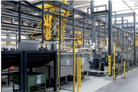
**Agile Produktion mit neuartigem Verfolgungssystem: Die wechselbaren Wannen mit unterschiedlichen Konzentrationen für Gleitmittelbeschichtung sind mit RFID-Sensoren ausgestattet** (Bild: B+T)
