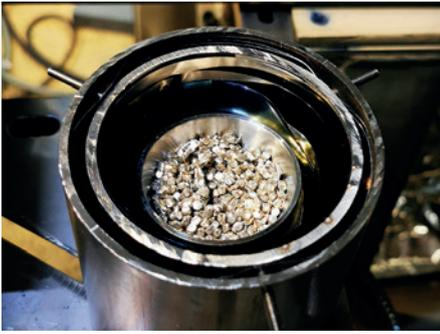
**Lithium in Ausgangsform als Granulat und abgeschieden als dünne Schicht als Grundlage zur Fertigung von innovativen und effizienten Batterien der nächsten Generation** © Fraunhofer FEP
