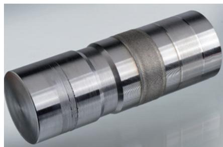
**Fertig bearbeitetes Bauteil mit (v.l.) Defekt, Nutgeometrie, Füllvolumen in Nut, nachbearbeitetes Füllvolumen** (Bild: Fraunhofer ILT)
