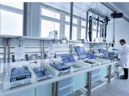
**Anlage zur Beschichtung aus dreiwertigen Hartchromelektrolyten mit einem Fassungsvermögen von 400 Litern am Fraunhofer IPA (Bild: Fraunhofer IPA)**
