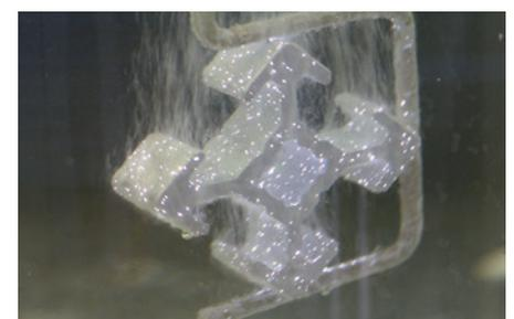
**PCO®-Verfahren zur Erzeugung definierter Schichteigenschaften auf Titan, Aluminium oder Magnesiumlegierungen (Bild: Innovent)**
