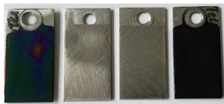
**Abb. 2:** Makroaufnahmen von iridiumoxidbeschichteten Blechen
