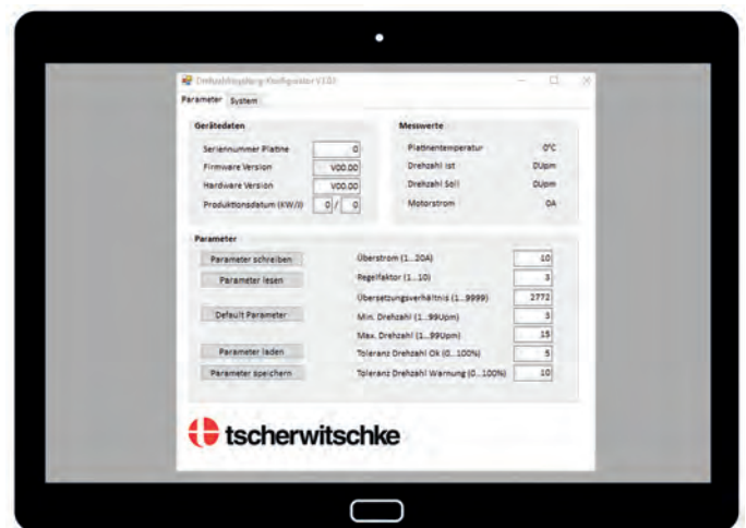
Über die Konfigurationssoftware kann der zur Verfügung stehende Drehzahlbereich vorgegeben werden (® Richard Tscherwitschke GmbH)
