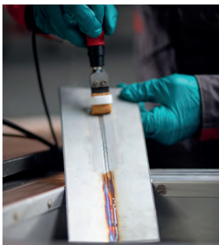
Vorher und Nachher im Vergleich: Einfach und schnell wird die WIG-Schweißnaht elektrochemisch gereinigt; das Reinigungsbad wird dabei automatisch mit Elektrolytflüssigkeit versorgt (Foto: Fronius International GmbH)
