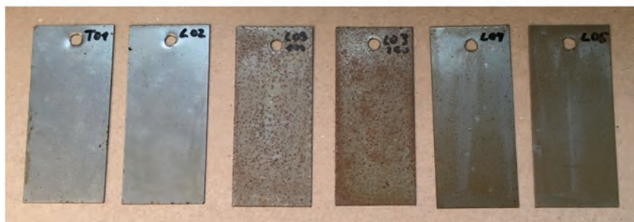
Abb. 5: Proben nach Bewitterung bei nahezu 100 % r.h.: obere Reihe nach zwei Tagen, untere Reihe nach 65 Tagen
