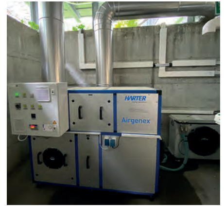
Das Entfeuchtungsmodul, das die Prozessluft aufbereitet, kann bei Platzmangel separat installiert werden; durch eine isolierte Verrohrung ist es mit dem Trockner verbunden
