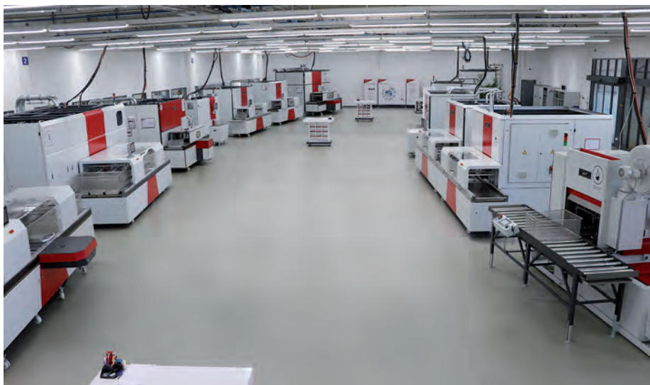
Im Kompetenzzentrum der Pero AG in Königsbrunn stehen 15 bis 17 Serien-Reinigungsanlagen, auf denen regelmäßig Testreinigungen von Kundenbauteilen durchgeführt und neueste Technologien präsentiert sowie Schulungen und Validierungen von Maschinenverbesserungen durchgeführt werden (Bild: Pero AG)
