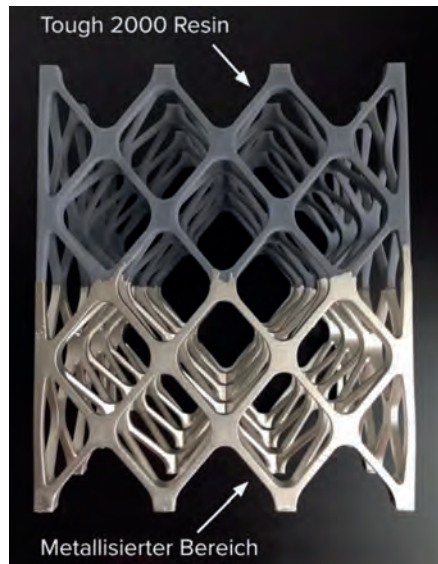
Hybridtechniken erweitern die Materialeigenschaften, die mittels 3D-Druck erreicht werden können (Bild: Formlabs/AMPro 3D)
