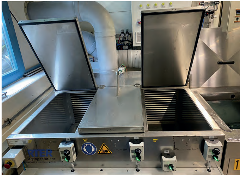
Die drei Kammern des Korbtrockners sind autark und können unabhängig voneinander betrieben werden; Harter-Trockner werden staatlich bezuschusst
