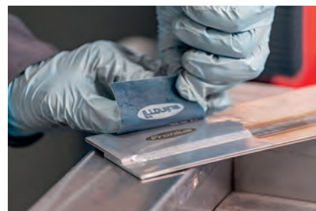
Schwarz- oder Weißprint zur dauerhaften Beschriftung von Edelstahlwerkstücken erspart das Prägen, Gravieren oder Bekleben (Foto: Fronius International GmbH)
