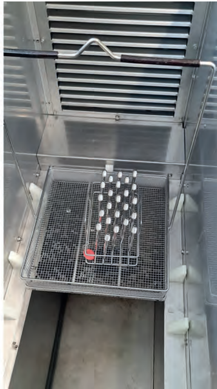
Korb mit Teilen beim Einlassen in den Trockner, die bei 70 °C auch im Falle von geometrisch anspruchsvollen Teilen in 15 Minuten schonend und sicher getrocknet werden
