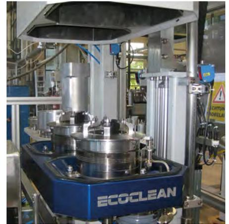
**Trockenreinigungsverfahren wie beispielsweise die Vakuum-Luftreinigung lassen sich unter anderem in Montagelinien integrieren und zur Entpulverung von additiv gefertigten Teilen einsetzen (Bild: Ecoclean)**
