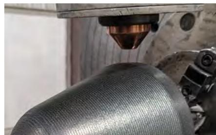
**Verschleißteile wie dieser Steinbrecherzahn mit einem Durchmesser von etwa 140 mm werden mit dem LMD-Prozess wiederhergestellt. Mit KI werden Prozesse für die Reparatur unregelmäßiger Oberflächen optimiert**
