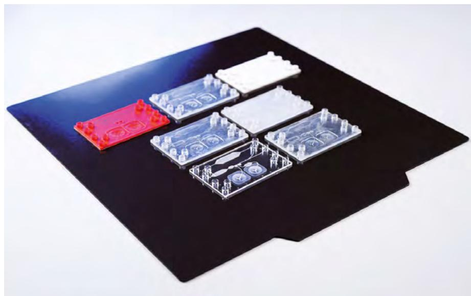
**Im Projekt SIMPLE-IVD werden Designregeln entwickelt und getestet, mit denen es möglich ist, In-Vitro-Diagnostik-Kartuschen funktional gleichwertig über verschiedene Herstellungsverfahren zu produzieren**
