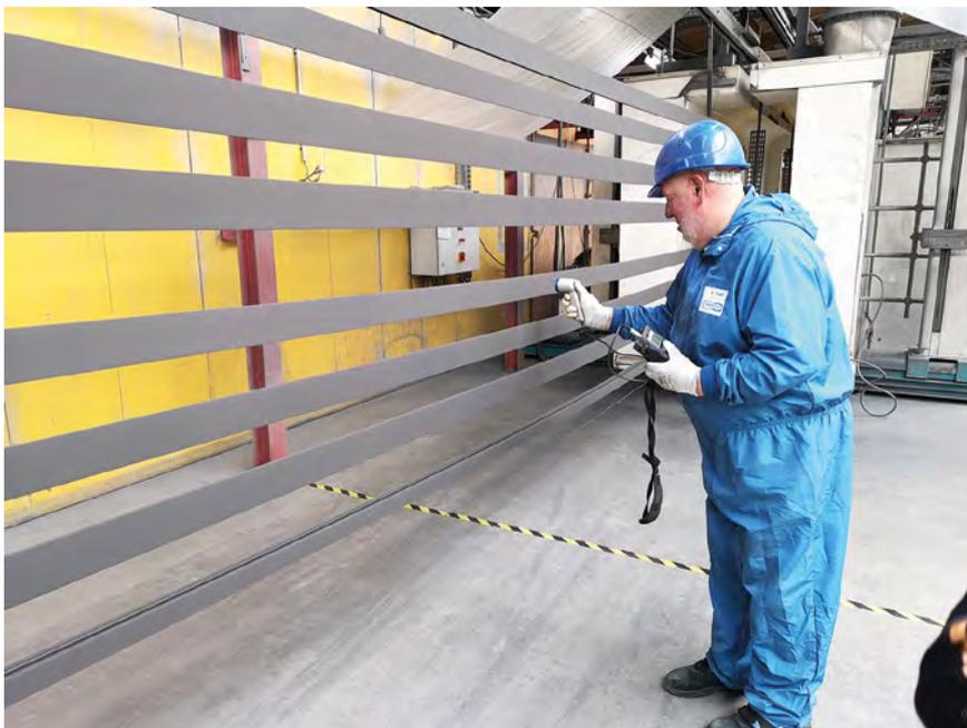
**35** Aluminiumbeschichtung: Schichtdickenmessung in der Produktion
