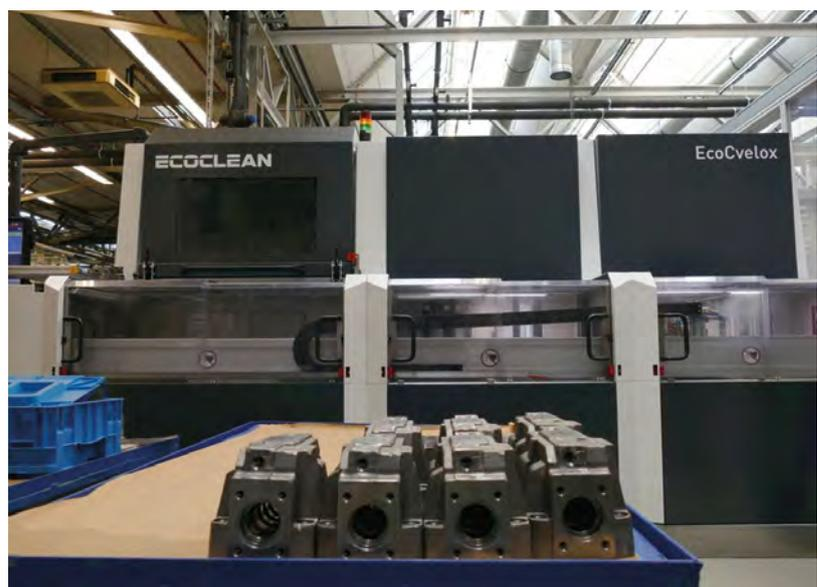
**Die Kombination von Hochdruck-Wasserstrahlentgraten und Niederdruck-Teilereinigungsprozessen ermöglicht die effiziente und automatisierte Einzelteilbearbeitung von beispielsweise Hydraulikteilen in verketteten Fertigungsumgebungen (Bild: Ecoclean)**
