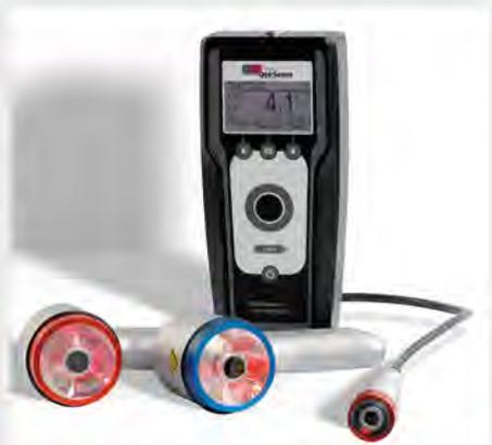
**Der PaintChecker mobile misst sämtliche Farbtöne mit einer einzigen Einstellung**
