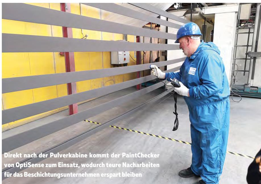
Direkt nach der Pulverkabine kommt der PaintChecker von OptiSense zum Einsatz, wodurch teure Nacharbeiten für das Beschichtungsunternehmen erspart bleiben
