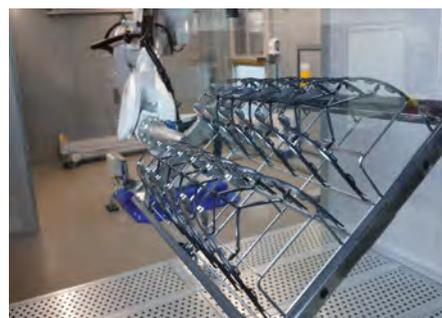
**Abb. 3:** Blick auf das Lackierack mit den Vergleichsteilen
