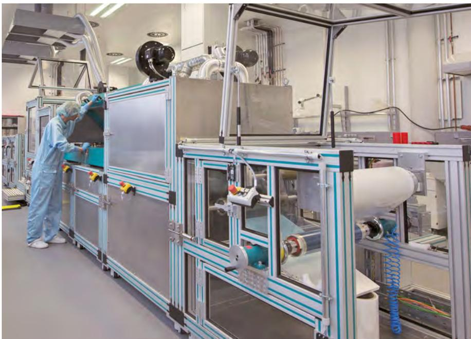
**Die Beschichtungen werden im Rolle-zu-Rolle-Verfahren hergestellt. Mit wenigen 100 µm sind die elektrochrome Folie als auch das thermochrome Dünnglasssubstrat extrem dünn (© Fraunhofer)**
