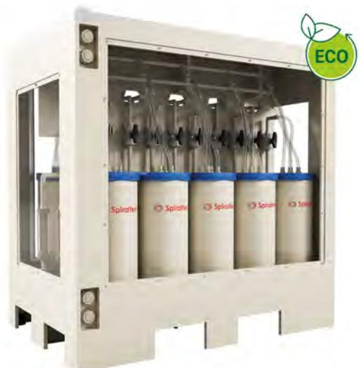
Spiraltec produziert als weltweit erstes Unternehmen gewickelte Membranmodule für die Diffusionsdialyse.
