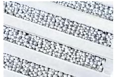
**Wärmetauscher gefüllt mit aluminiumbeschichtetem Zeolithgranulat**
