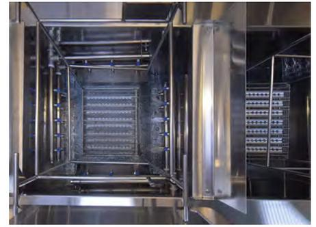
**In den speziell für die Feinstreinigung entwickelten Tauch-Spritzspülen werden die Teile beim Herausfahren abgespritzt, was den Spülflekt verbessert** (Bild: Zeiss)
