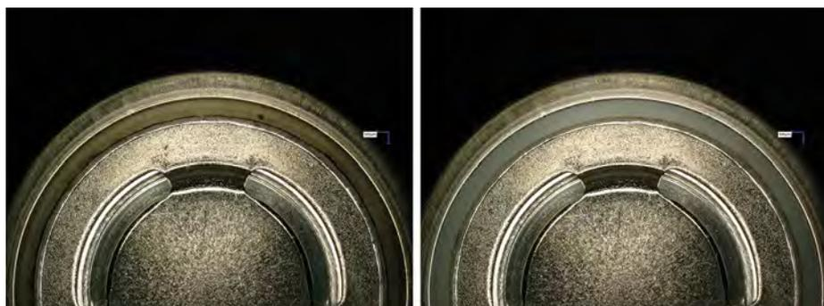
Durch das Zusammenspiel von vier Reinigungsmechanismen entfernt der quattroClean-Strahl partikuläre und filmische Verunreinigungen prozesssicher und reproduzierbar von den Kontaktstellen der Batteriezelle (Bild: acp systems AG)
