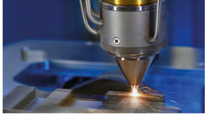
**3D-Druck eines Fraunhofer ILT-Schriftzuges aus drei verschiedenen Pulverwerkstoffen als Demonstratorbauteil für das neue, hochproduktive EHLA-3D-Verfahren**
