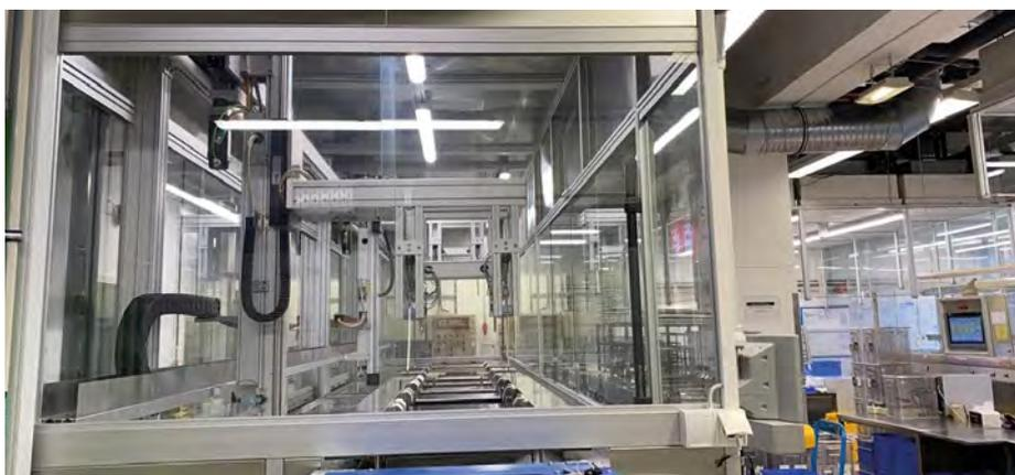
**Die verschiedenen Behandlungsstationen der anwendungsspezifisch ausgelegten Ultraschall-Feinstreinigungsanlagen können flexibel angefahren und definierte Prozesse priorisiert werden (Bild: Philips Medical Systems)**
