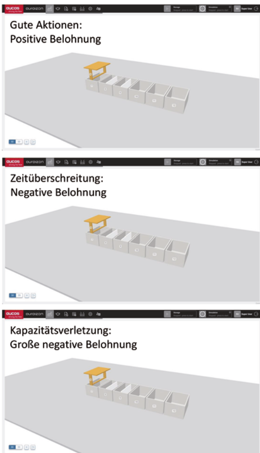
Die KI für eine Anlagensteuerung erlernt auf Basis eines Belohnungssystems für getätigte Aktionen (Bild: Aucos)
