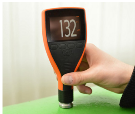
Abb. 2: Berührungsbehaftete Messverfahren wie die Wirbelstromtechnik (links) setzen direkt auf dem Werkstoff auf, während das kontaktlose und zerstörungsfreie Photothermieverfahren (rechts) aus der Distanz arbeitet (Bild: shutterstock_1693123939)
