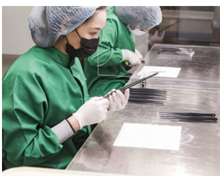
Abb. 1: Bei chirurgischen Instrumenten werden höchste Ansprüche an Material, Beschichtung, Konstruktion und Fertigung gestellt. Neben strengen Hygienestandards muss die Oberfläche auch haptischen, ergonomischen und technischen Anforderungen wie Durchschlagsfestigkeit genügen, wofür eine präzise Schichtdicke überaus wichtig ist (Bild: Adelhelm Kunststoffbeschichtungen)
