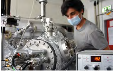
Marvin Schmidt führt Proben des Katalysatormetalls ins Rastertunnelmikroskop ein, um atomare Veränderungen auf der Oberfläche zu untersuchen (© Julia Siekmann, Uni Kiel)
