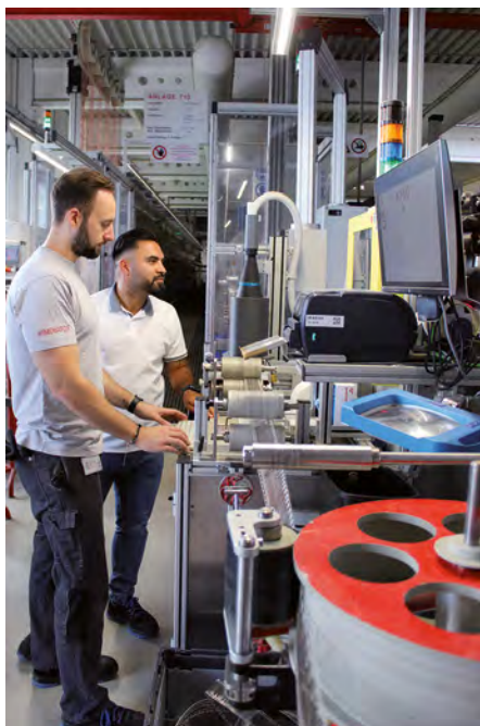
Ayhan Gümüş, Produktionsleiter Bandgalvanik mit Teamleiter Alessandro Luciano am hochpräzisen Kameravermessungssystem an einer annähernd 90 m langen Bandanlage, so dass dank einer 100%-Prüfung kein verbogener Teil an den Kunden geht
