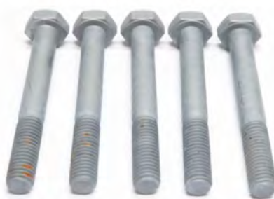
Kondensklimatest nach DIN EN ISO 6270-2
