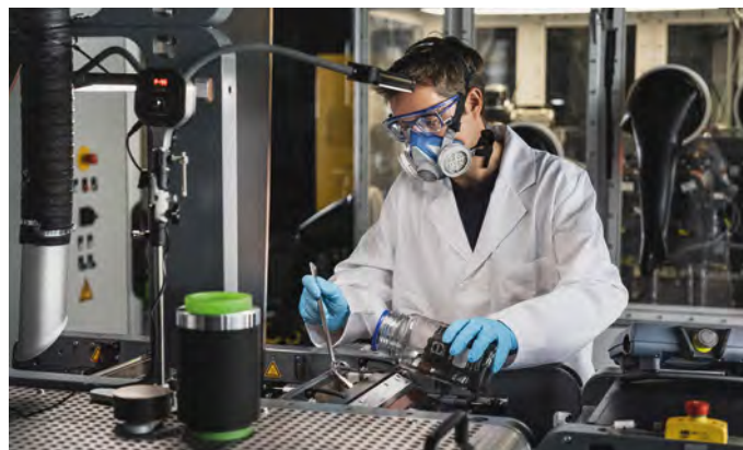
Das trockene Ausgangsmaterialgemisch wird in den Kalanderspalt der DRYtraec®-Anlage gegeben (© Fraunhofer IWS Dresden)
