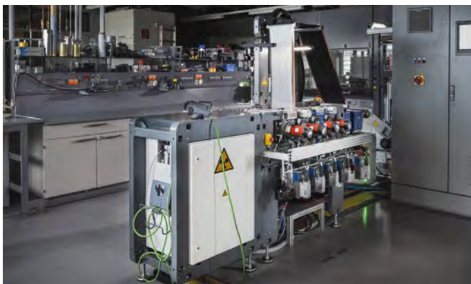
DRYtraec®-Anlagen benötigen keine langen Trocknungsstrecken und nehmen daher deutlich weniger Platz ein (© Fraunhofer IWS Dresden)
