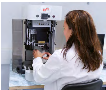
Tribometer mit elektrochemischer Messzelle für Tribokorrosionsmessungen; die Messzelle wurde am Fraunhofer IPA entwickelt (Bild: Fraunhofer IPA/Sina-Helena Gross)
