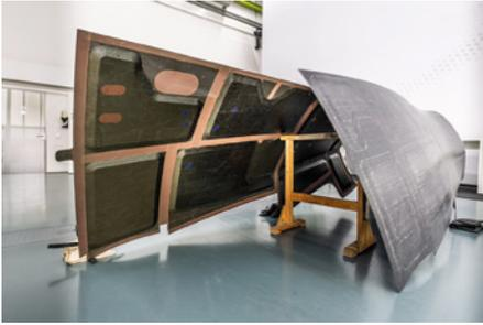
**Die ausgehärteten Seitenschalen, bereit für den Einbau im RACER Helikopter Prototyp**
