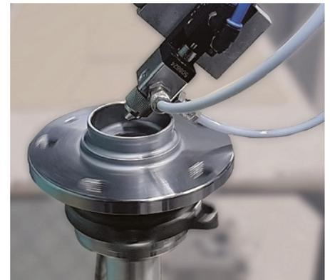
**Das optimierte Spritzverfahren ermöglicht es, Bauteile randscharf, ohne Maskierung mit Zinklamellensystemen zu beschichten**
