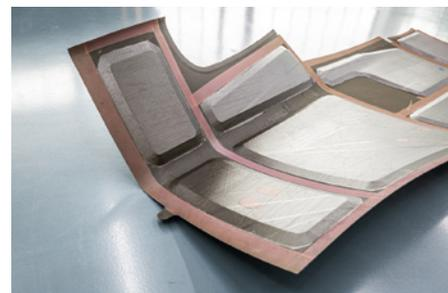
**Eine der ausgehärteten Seitenschalen, bereit für den Einbau im RACER Helikopter Prototyp** (© Airbus Helicopters GmbH)
