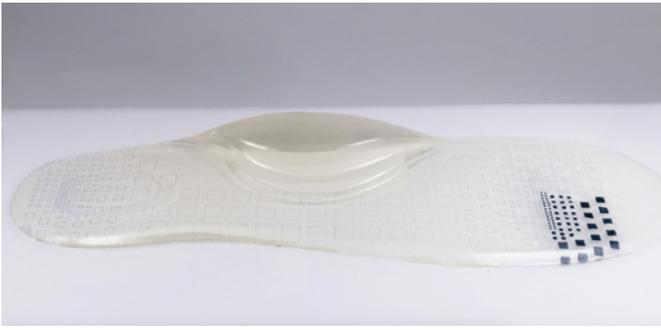
**Piezosensoren sollen in Schuheinlagen eingedruckt dabei helfen, die Gewichtsverteilung zu analysieren, und daraus folgend Haltungsschäden vorbeugen**
