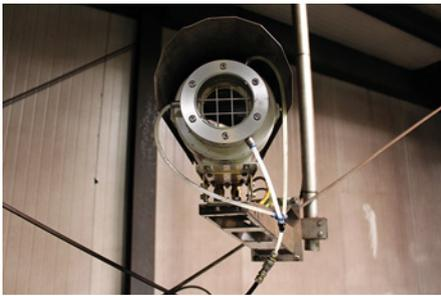
**Abb. 3: Die Kameras sind wegen der rauen Umgebungsbedingungen und der potentiell explosiven Atmosphäre in einem Ex-Schutzgehäuse untergebracht; eine integrierte Freiblaseeinrichtung hält die Optik permanent staubfrei (Bild: Polytec)**
