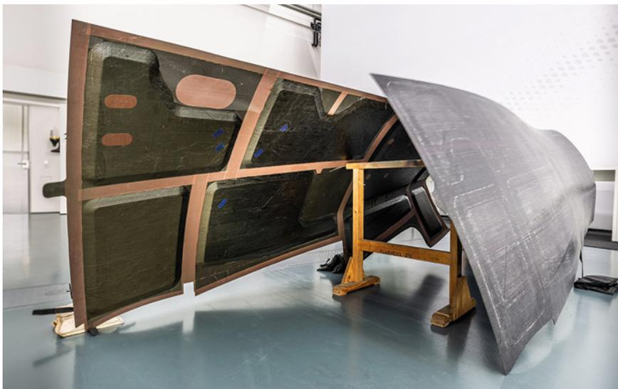
**10** Automatisierte Fertigung von CFK-Verbundteilen in der Flugzeugindustrie
