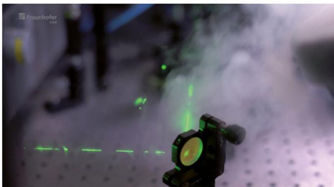
Präzise Fokussierung des Laserstrahls über Spiegel und Linsen auf die Oberfläche der Probe
