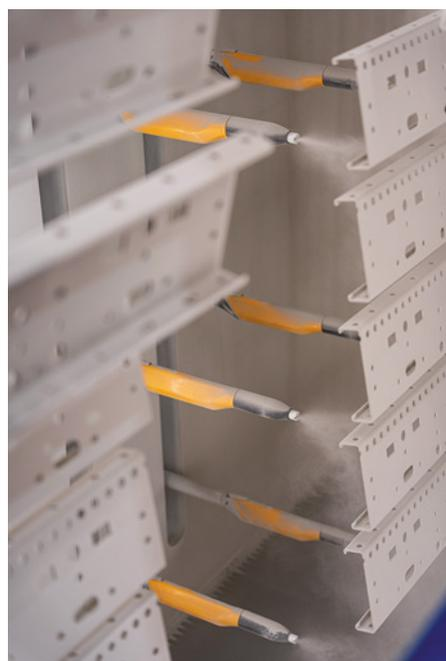
**Die neue Pulverbeschichtungskabine und die Automatikpistolen in Aktion** (Bild: ZINQ/BjörnBild)
