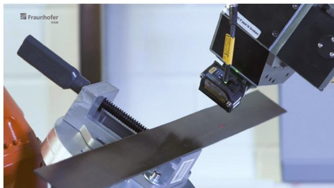
Kompakter LIBS-Messkopf am Robotersystem zur automatisierten Vermessung von Bauteilen
