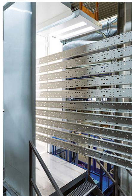
**Die fertig beschichteten Profile in RAL 7035 oder Lichtgrau** (Bild: ZINQ/BjörnBild)
