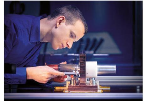
**Beim Magnetpulsschweißen sorgt der magnetische Druck einer Werkzeugspule für eine Hochgeschwindigkeitskollision und das Ausbilden einer stoffschlüssigen Überlappverbindung mit mehreren Millimetern Breite sowie hoher Stabilität und Dichtigkeit auch bei extremen Einsatzbedingungen**
