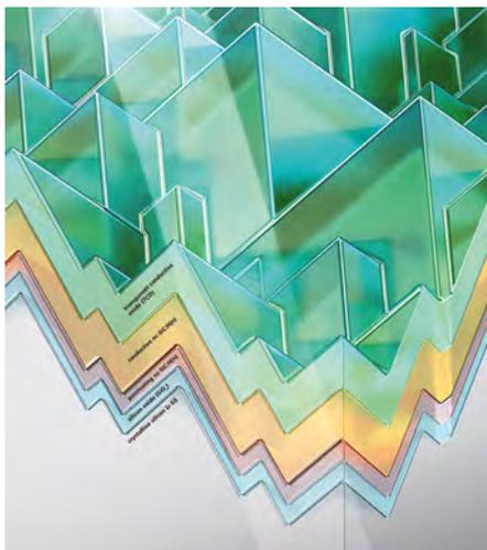
**Schichtfolge der neuen Solarzellen mit durchsichtigen Frontschichten (TPC) auf einem Wafer mit zufälliger Pyramidenstruktur: n-dotierter kristalliner Siliziumwafer (grau), nasschemisch gewachsenes Siliziumdioxid (hellblau), passivierendes Siliziumkarbid (rot), leitendes Siliziumkarbid (orange), Indiumzinnoxid (grün)** ©Forschungszentrum Jülich
