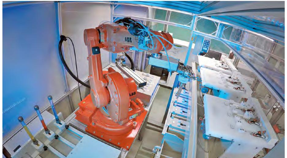
**Der Roboter stellt den pH-Wert des Prozessbades über eine Pipette ein, bevor er das nächste Blech aus dem Magazin aufnimmt. Dieser Schritt ist notwendig, weil der pH-Wert Einfluss auf die Schichteigenschaften des Blechs hat und damit zum Beispiel auch auf den Korrosionsschutz**
