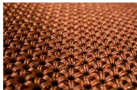
**Der wertvolle Copper Rug besteht aus Tausenden von verknüpften Kupferringen; bei der manuellen Herstellung lief das Material dunkel an und benötigte einen aufwendigen Reinigungsprozess** (Bild: OTH/OTG)
