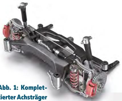
Abb. 1: Kompletter Achsträger
