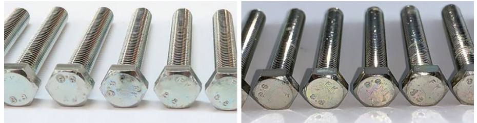
Alkalisch Zink mit Passivierung DELTA®-PASSIVATION SHINY 30 und Topcoat im Vergleich: unbelastet (l.) und nach 720 h Korrosionstest gemäß DIN EN ISO 9227 (r.)
