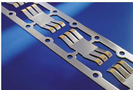
Selektive Goldkontakte auf Metallbauteil mittels Druck- und Laserverfahren
