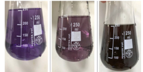
Abb. 4: Gegenüberstellung von Neuansatz, 3S-Elektrolyt und konventionellem Elektrolyt
