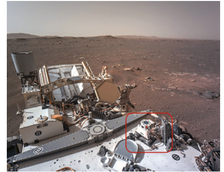
Technologie des Fraunhofer IST auf dem Mars: Der Interferenzfilter ist Bestandteil eines optischen Sensors zur Staubcharakterisierung im Mars Environmental Dynamics Analyzer
