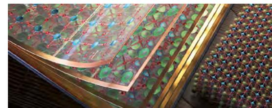
**Forschende aus Jülich, Aachen, Stanford und Berkeley haben den schichtweisen Aufbau eines Katalysatormaterials untersucht (als einzelne Lagen (li.) und in der vollen Kristallstruktur (re.) dargestellt) und herausgefunden, dass eine atomar dünne Oberflächenschicht die Aktivität für die Wasserspaltungsreaktion verdoppeln kann** (© CUBE3D Graphic)
