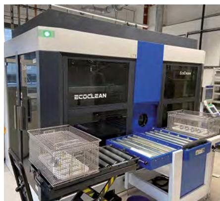
**Die Reinigung der Komponenten von Spiralrillennaglern soll in einer Standardanlage erfolgen; Reinigungsversuche vor der Investition ergaben, dass mit der EcoCwave die geforderten Ergebnisse erzielt werden**
