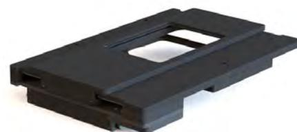
**Mikroskoptisch mit magnetischer Positionierung** (© ITK Dr. Kassen GmbH)
