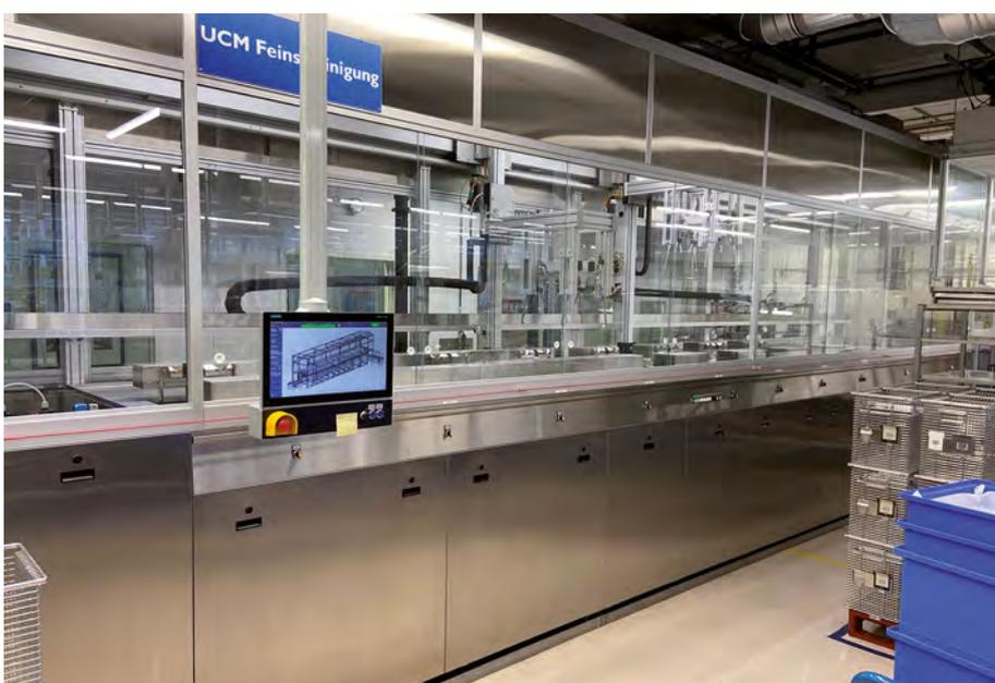
**Die mit zwölf Behandlungsstationen ausgestattete Ultraschall-Feinstreinigungsanlage gewährleistet, dass bei der Endreinigung der Teile von Röntgenröhren die Sauberkeitspezifikationen zuverlässig eingehalten werden (Bild: Philips Medical Systems DMC GmbH)**
