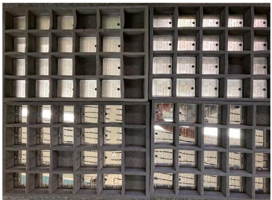
**Abb. 1: Ziel- und Grenzmuster der Farbe Chrom wurden mittels PVD-Technik in unterschiedlichen Strukturen erstellt**
