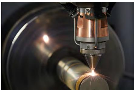
**Dank einer zusätzlichen A-Achse lassen sich mit dem EHLA-Auftragskopf bis zu 1490 mm lange Bauteile mit einem Maximaldurchmesser von 320 mm beschichten** (©toolcraft)
