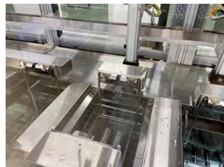
**Die integrierte Spritzspüle mit VE-Wasser entfernt auch sehr feine Stäube, die sich nach der Reinigung und dem ersten Tauchspülen noch auf der Oberfläche befinden**
