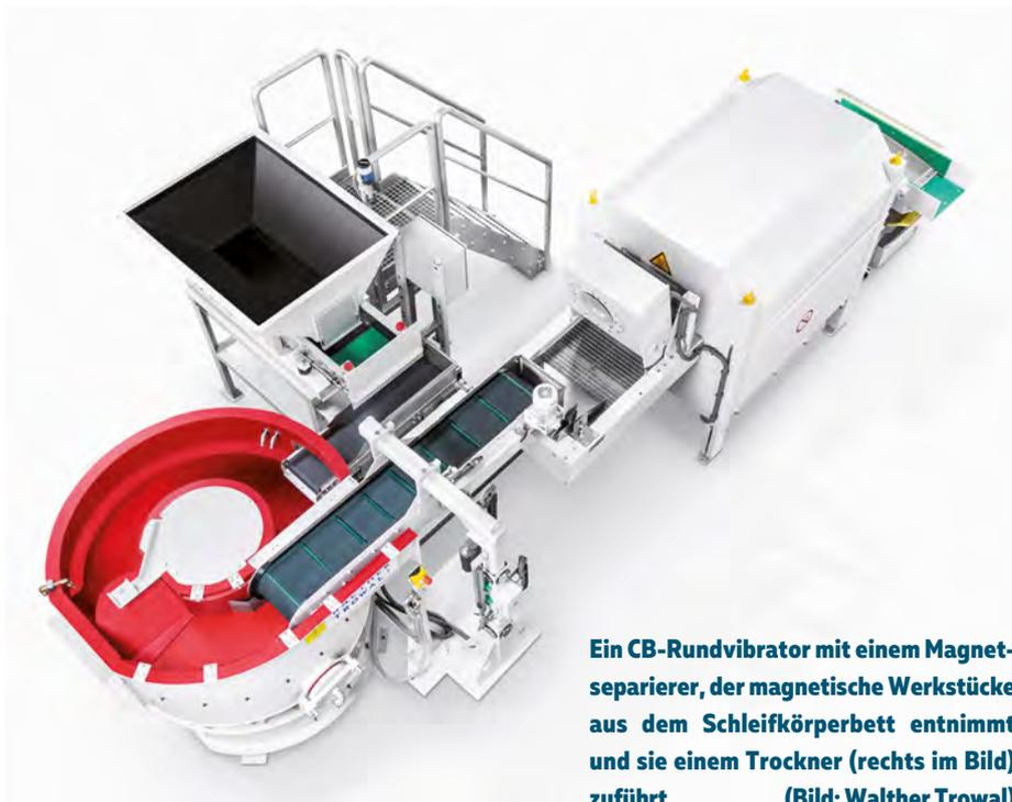
Ein CB-Rundvibrator mit einem Magnetseparierer, der magnetische Werkstücke aus dem Schleifkörperbett entnimmt und sie einem Trockner (rechts im Bild) zuführt (Bild: Walther Trowal)
