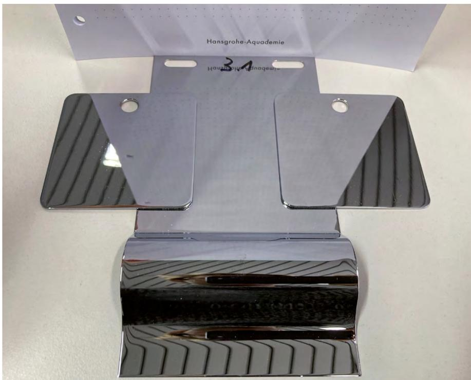
**Abb. 2: Für den Abgleich einer dreiwertigen Verchromung wird die Chrom(VI)farbe als Ziel (links) mit einer Musterplatte aus dem Chrom(III)verfahren (Mitte) und einem Grenzmuster Chrom (max. zulässige Verfärbung) (rechts) herangezogen**
