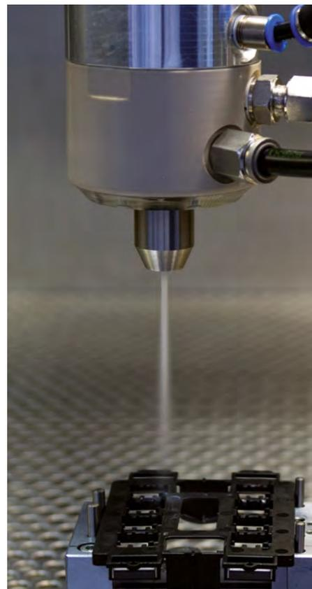
**Die neue Düse erzeugt einen pulsierenden Strahl mit einer Frequenz von 25 bis 30 Hertz; er besitzt eine höhere kinetische Energie**
