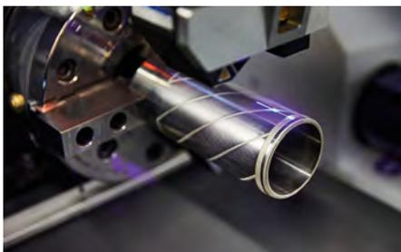
**Ein Linienscanner prüft eine Beschichtung** (©Fraunhofer ILT, Aachen/R. Baumgarten)
