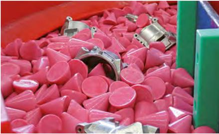
**Druckgussteile im Schleifkörperbett**
