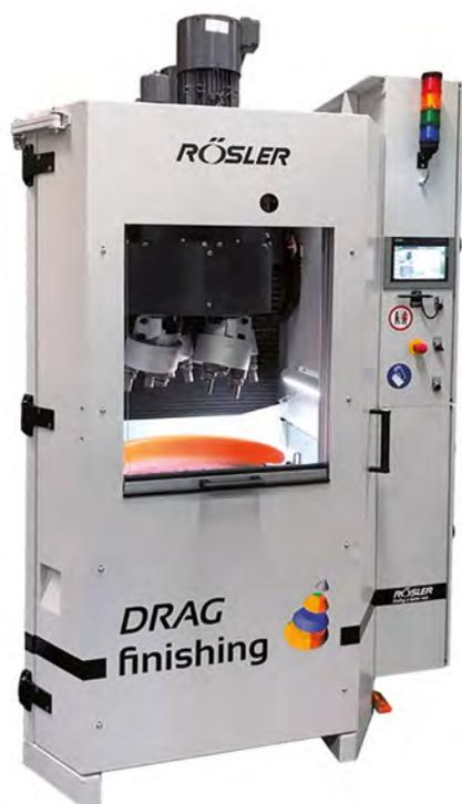
**Der kompakte und universell einsetzbare Schleppfinisher R 4/700 SF verfügt über ein Karussell mit vier Arbeitsspindeln für jeweils drei Werkstücke. Separate Antriebe von Arbeitsbehälter und Spindeln ermöglichen, dass deren Bewegungen individuell und unabhängig voneinander einstellbar sind. Für eine ergonomische, einfache und schnelle Bestückung der Arbeitsspindeln kann der Schleppfinisher per Knopfdruck zur Beladeposition gefahren werden**
