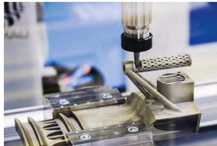
**Automatische, bauteilspezifische Nachbearbeitung durch einen Roboter mit anschließender Verifizierung durch 3D-Scan am Fraunhofer IWU in Chemnitz (© Fraunhofer)**
