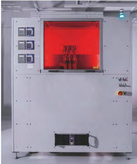
**Anlage für das Multi Material Jetting von Hochleistungskomponenten mit kombinierten Eigenschaften oder Funktionen**
