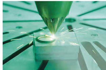
Am Fraunhofer IWS in Dresden wird das einsetzbare Spektrum von additiv verarbeitbaren Werkstoffen erweitert. Mittels maßgeschneiderter Laserauftragschweißprozesse lassen sich metallische Multi-Material-Bauteile realisieren (© Fraunhofer)
