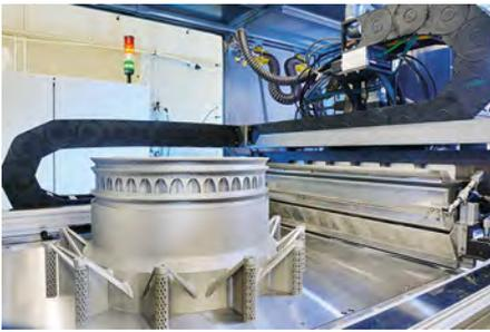
**Mehrere Laser am Fraunhofer ILT, Aachen, verwandeln Metallpulver per 3D-Druck in ein Demonstratorbauteil für die künftige Triebwerks-genera-tion von Rolls-Royce (© Fraunhofer)**
