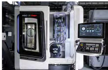
Fünf-Achs Bearbeitungszentrum HSC30 mit Kopplung an Prozesssimulation (© IFW)
