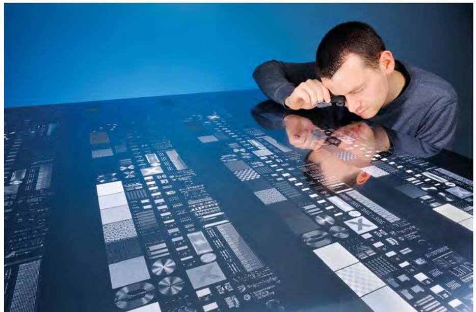
**Großformatige (1 m x 1,5 m) Prägeplatte, die mit dem neuen Multistrahlschneidsystem erzeugt wurde**
