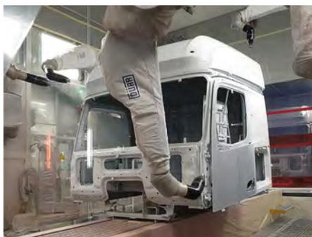
**Eco Paint Process Trucks« in Aktion bei der Daimler Truck AG** (Bild: Daimler Truck AG)
