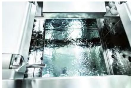
**Alle Wannen für Nassstufen der komplett aus elektropoliertem Edelstahl gefertigten Anlage verfügen über einen Zweiseitenüberlauf, durch den abgereinigte Partikel und andere Verschmutzungen sofort ausgetragen werden. Dies minimiert das Rückkontaminationsrisiko beim Umsetzen der Teile**
