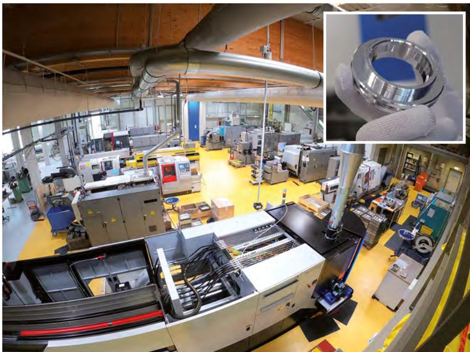
**In der Fertigung von Mattig stehen hochmoderne Dreh-Fräszentren. Die dort hergestellten Bauteile – wie der abgebildete Präzisionsdichtring – kommen unter anderem im Motorsport zum Einsatz**
