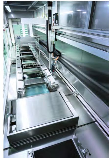
**Die Anlagen können mit bis zu neun Reinigungs- und Spülstufen sowie variabel mit Mono-, Dual- und Multifrequenz-Ultraschall ausgestattet werden**
