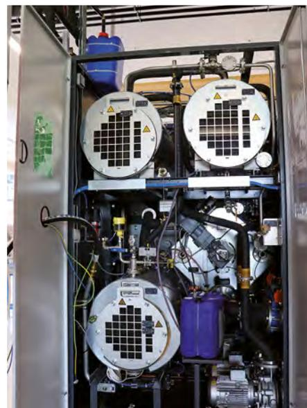
**Die automatische Wartung von Reinigungsmedium, Destille und Filter erleichtert den Umgang mit der neuen Anlage Pero R1** (Bild: Pero AG)
