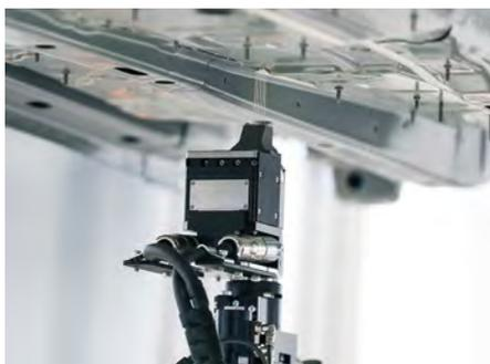
**Dichtstoffapplikation mit dem neuen System IDDA.Seal** (Bild: Atlas Copco IAS GmbH)
