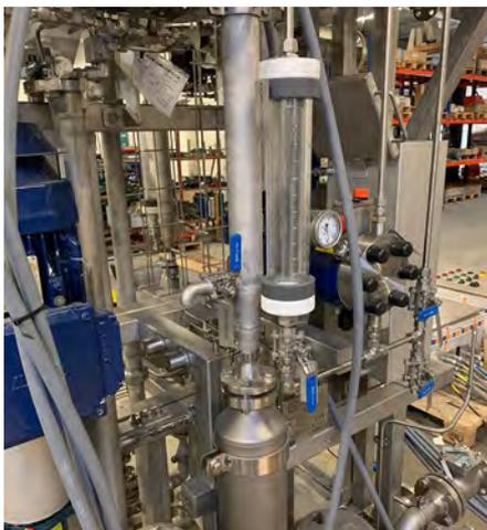
**Eingebaute Kalibriersäulen zur Kalibrierung der Dosierpumpe oder als Ansaughilfe für die Dosierpumpe, hier mit einem Fassungsvermögen von 2 Litern mit Säulen aus Borosilikatglas mit PTFE-Anschlüssen und damit hoch chemikalienbeständig (Bild: Chemfeed)**
