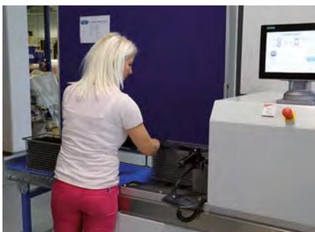
**Nach dem Einlesen eines Barcodes zur Programmzuordnung, stellt die Produktionsmitarbeiterin Stanojka Tadic von Mattig ihre Bauteilkörbe zweireihig auf die Zuführung und startet den Reinigungsvorgang in der Pero R1 am Touch Panel** (Bilder: Pero AG)
