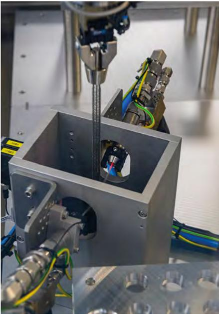
**Während der Reinigung rotiert der Stent und wird in der Prozesskammer auf- und ab bewegt. In die Kammer ist eine leistungsfähige Absaugung integriert, die abgelöste Verunreinigungen und das sublimierte Kohlendioxid zuverlässig entfernt und Rekontaminationen verhindert** (Bild: acp)
