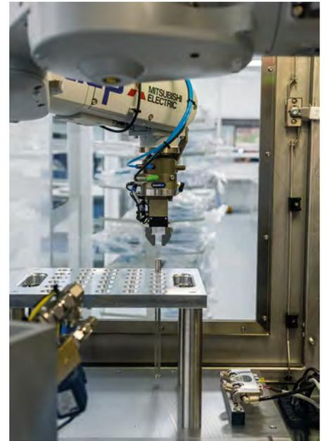
**Der Roboter positioniert die gereinigten Stents in einem Tray auf der Reinraumseite des Reinigungsmoduls; das Tray wird für die abschließende Katheterintegration und Sterilisation im Reinraum manuell entnommen** (Bild: acp)
