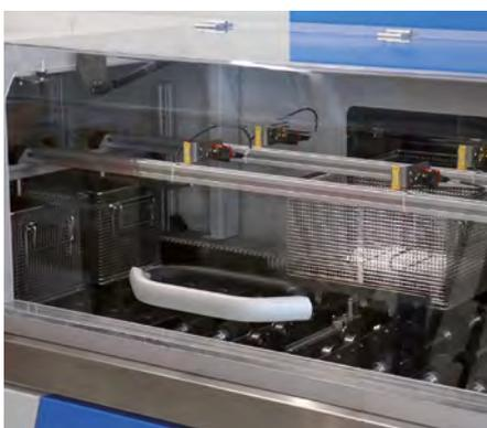
**Vollautomatisch erfolgt die Zu- und Ausführung der Bauteile in den Arbeitsraum der unter Vollvakuum arbeitenden lösemittelbasierten Reinigungsanlage Pero R1** (Bild: Pero AG)
