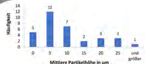
Abb. 7: Stereoskopische 3D-Darstellung aus den Einzelbildern von REM-Aufnahmen und Partikelgrößenverteilung in einer Dispersionschicht
