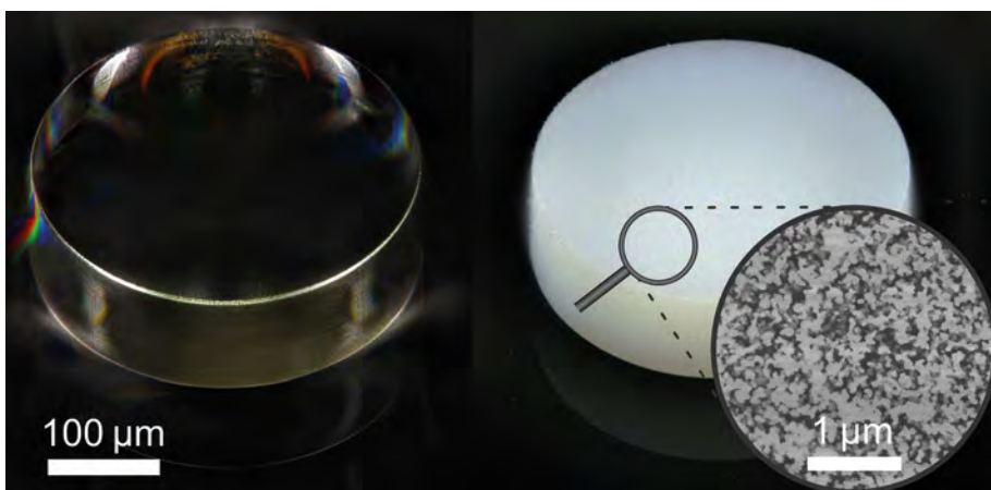
Farbwechsel: Der rechte, mit dem neuartigen Fotolack gedruckte Mikro-Zylinder erscheint weiß, weil in seiner schwammartigen Struktur das Licht gestreut wird, während der aus herkömmlichem Fotolack gedruckte Zylinder transparent erscheint (Foto: 3DMM2O)
