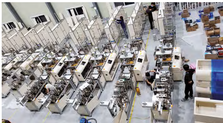
Abb. 4: Ultraschalltechnologie hilft HJ PNC im Kampf gegen COVID-19: Das Unternehmen produziert pro Monat 70 vollautomatische Maschinen für die Fertigung von Atemschutzmasken (Quelle: HJ PNC)
