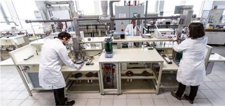
**Der Elektrolytprüfstand am Fraunhofer IPA ermöglicht es, durch seinen standardisierten Aufbau verschiedene definierte Probekörper (Rundstab und Profilkörper) bei gleichbleibender Versuchsumgebung zu beschichten**
