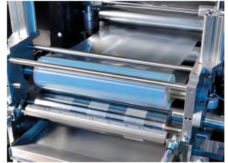
**Strukturierte Oberflächenfunktionalisierung von Folien mittels R2R-Technologie, zum Beispiel für die Herstellung von Microarrays**
