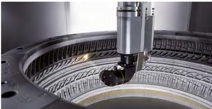
Abb. 7: Laserreinigung einer Reifengussform
