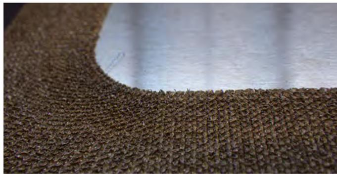
Abb. 8: Laserstrukturierte Metalloberfläche
