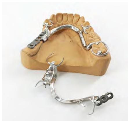
**Der Klammermodellguss zählt zu den additiv gefertigten Werkstücken, die mit dem innovativen Trockenpolierverfahren bearbeitet werden. Statt einer Stunde händischer Polierarbeit werden nun nur noch circa 30 Minuten benötigt. Zudem können mehrere Teile gleichzeitig bearbeitet werden**
