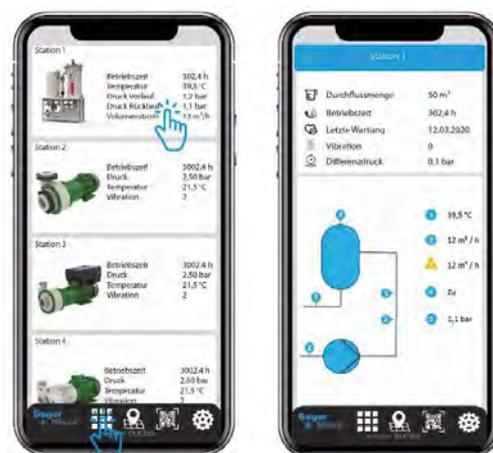
Zustandsdaten einer Pump- und Filterstation sind auf den allgegenwärtigen Mobilgeräten verfügbar (Bild: Sager + Mack)
