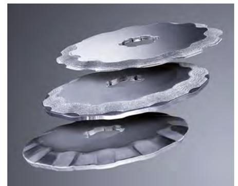
**Abb. 2: Drei Fertigungsstadien für das LMD von Schneidscheiben eines Maishäcklers; vor der Beschichtung (unten), beschichtetes Bauteil mit einer Hartstoffschicht (Mitte) sowie fertig bearbeitetes Bauteil (oben) (Quelle: Trumpf)**
