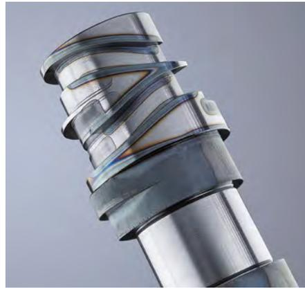
**Abb. 4: Randschichthärten einer Nockenwelle**
