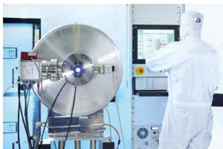
Die EUV-Quelle am Fraunhofer ILT liefert 40 W bei 13,5 nm (+/- 1% Bandbreite)
