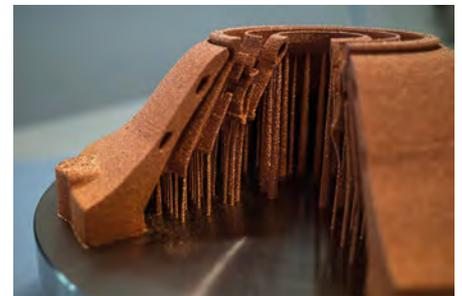
**Es entstehen schichtweise komplex geformte Kupferteile – zum Beispiel Kühlkörper**
