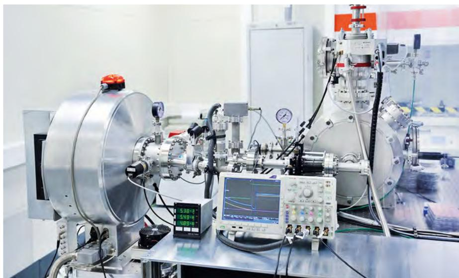
Am Fraunhofer ILT wurde ein Laborsystem für die EUV-Bearbeitung von Wafern mit bis zu 100 mm Durchmesser aufgebaut
