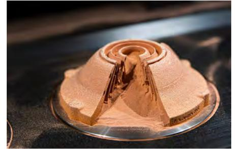
**Die neue additive Fertigungsanlage schmilzt reines Kupferpulver vollständig auf**
