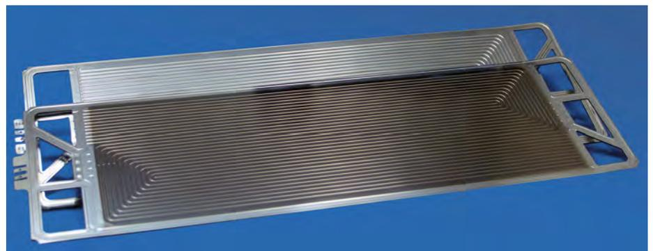
**Die Bipolarplatte von Daimler (oben) wird mit einer Kohlenstoffschicht versehen (unten), die den Kontaktwiderstand verringert und gleichzeitig die Korrosionsbeständigkeit erhöht (Bild: Fraunhofer IWS)**
