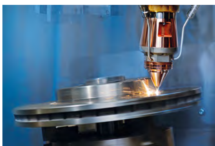
EHLA-Beschichtungsprozess einer Brems Scheibe (© Fraunhofer ILT, Aachen)
