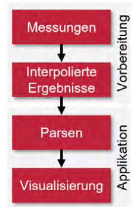
Abb. 4: Datenfluss von der Messung zur Visualisierung
