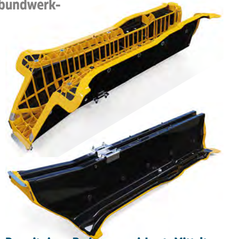
Der mit einem Preis ausgezeichnete Mitteltunnel in Hybridbauweise mit glasfaserverstärkter Rippenstruktur als CAD-Darstellung (Bild: Porsche, VW, TU Braunschweig)
