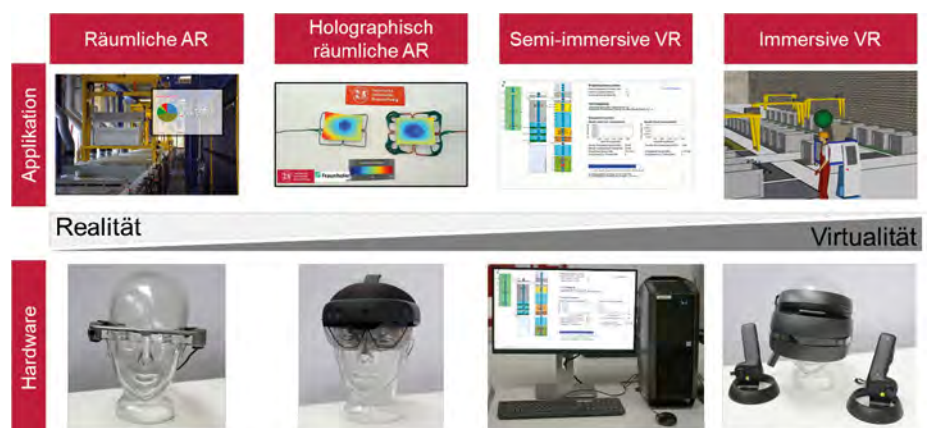
Abb. 1: Realität-Virtualität-Kontinuum unterstützt Auswahl der Visualisierungsform (basiert auf [1, 2])
