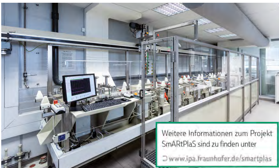
Der Kleingalvanikautomat am Fraunhofer IPA wird zur Lernanlage für Industrie 4.0-Lösungen aufgerüstet (Quelle: Fraunhofer IPA/Foto: Rainer Bez)
