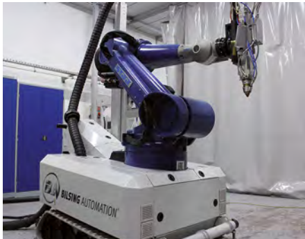
EHLA mobil: fahrbaren Roboter mit Laserstrahlquelle, EHLA-Bearbeitungskopf und Pulverzufuhrsystem (© Bilsing Automation)
