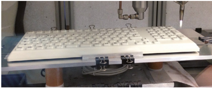
Abb. 2: Eine Tastatur für den medizinischen Gebrauch, beschichtet mit einer Zinkoxidhaltigen Wirkstoffschicht (Quelle: Innovent e.V.)
