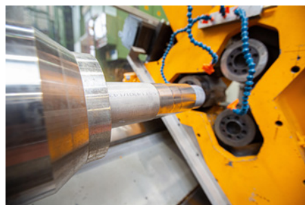
Drückwalzen: Die Spindel (vorne links) dreht das Stahlbauteil, das von den drei Walzen im Hintergrund umgeformt wird. Die blauen Leitungen sorgen für ausreichend Kühlschmierstoff (© Fraunhofer IEM)
