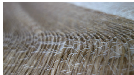
Flachsfaserbündel können im Tailored-Fiber-Placement-Verfahren zu Naturfaser-Preforms verarbeitet werden. Dieses Verfahren ist im ecoWing -Projekt Teil der Prozesskette
