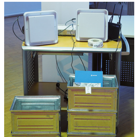
Mit RFID den Überblick behalten: Antennen lesen Transponder aus und melden diese Informationen automatisch an ein Lesegerät (Quelle: Softec AG)
