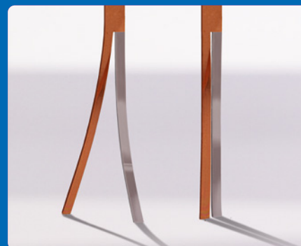
links: Standard chem. Nickelbad, rechts: SLOTONIP LP 1870 Prüfung nach ASTM Standard B975
