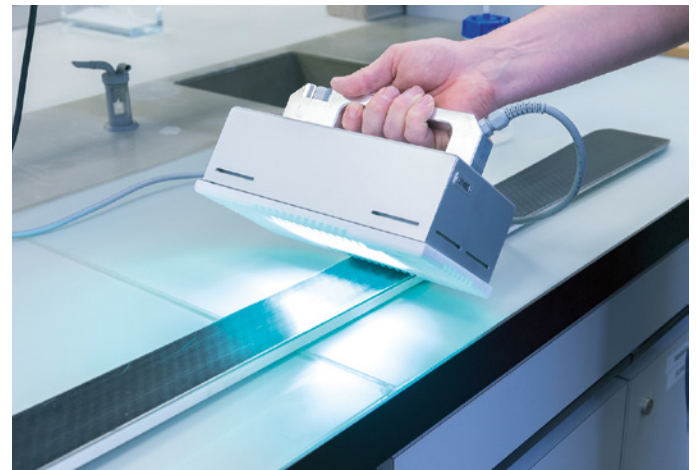
Abb. 3: Das Wachsen eines Skis mit Hilfe einer Quecksilberdampfampe
