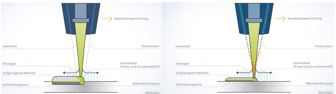
Abb. 1: Der Laserstrahl schmilzt das Pulver über der Verbindungszone (dem sogenannten Schmelzbad) auf, wodurch sich unter anderem besonders hohe Aufbauraten und Bearbeitungsgeschwindigkeiten erzielen lassen, wie auch der schematische Vergleich zwischen konventionellem Laserauftragschweißen (links) und Hochgeschwindigkeitslaserauftragschweißen erkennen lässt
