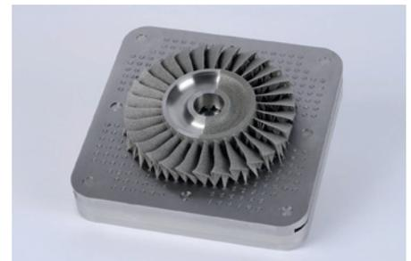
Das System basiert auf einer wiederverwendbaren Substratplatte aus Hochtemperaturstahl, in die Zylinderstifte eingelassen sind. Darauf können Werkstücke additiv gefertigt und nachbearbeitet werden (©Fraunhofer IPT)
