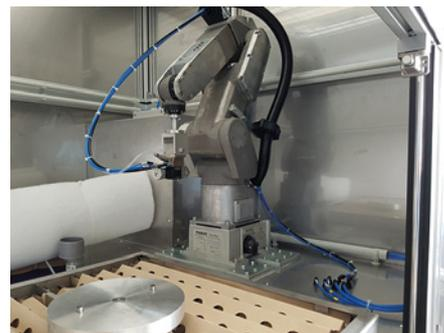
**Kompakte Lackierzellen mit speziell für die Beschichtungstechnik abgestimmten Robotern ermöglichen den kostengünstigen Einstieg in die roboterbasierte Lackierung (Bildquelle: Reiter Oberflächentechnik)**
